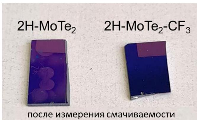
Рисунок 10 - Фото 2Н-MoTe<sub>2</sub> и 2Н-MoTe<sub>2</sub>-CF<sub>3</sub> после экспериментов по смачиваемости
