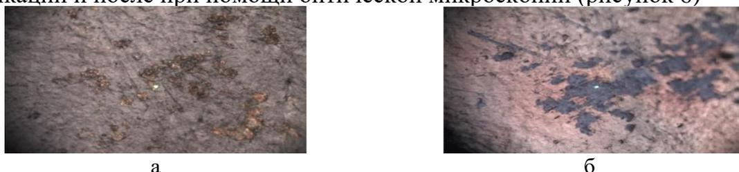
Рисунок 6 - Фото поверхности графитового электрода (увеличение в 1000 раз): а – поверхность ЗГЭ; б – поверхность ЗГЭ-Ar-COON
