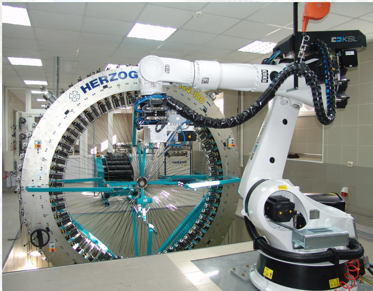
Изготовление преформ методом циркуляционного плетения
