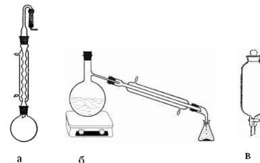
Рис. 3. Приборы и оборудование для получения сложного эфира: а) реакционная колба с обратным холодильником; б) реакционная колба с прямым холодильником; в) делительная воронка.
