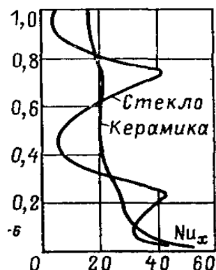
Рисунок. 5 Локальное число Нуссельта (керамическая и стеклянная пластинки с включенным нижним нагревателем) в зависимости от координаты x .
