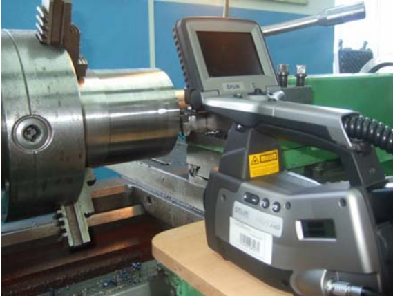
Рис. 3. Измерение теплового поля тепловизором ThermoCam P65 HS
