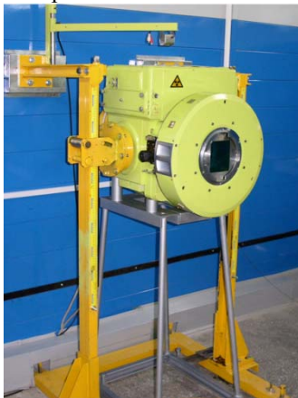
Рис.1 Дистанционно-управляемый источник гамма-излучения (Co-60) комплекса «Радиян»
