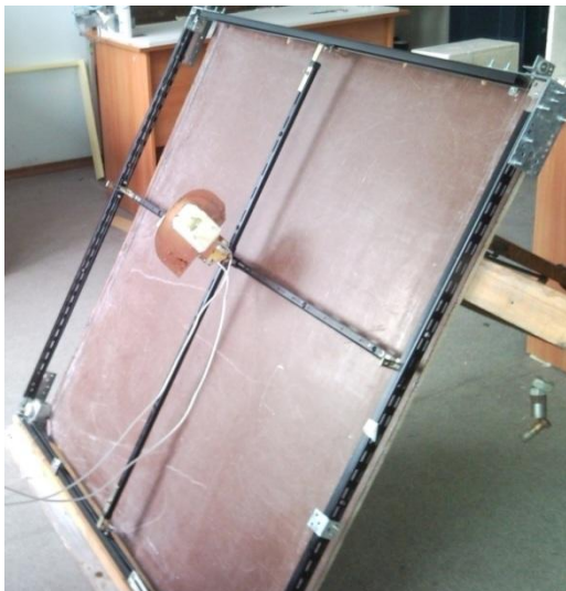
Рис. 4. Внешний вид установки для экспериментов по сверхширокополосному радиоволновому видению удаленных объектов
