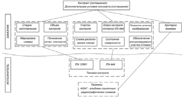
Рис. 3. Блок-схема взаимосвязи условий контракта с требованиями стандартов EN по РК отливок
