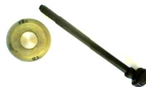
Рис. 2. Внешний датчик прототипа твердомера ТШМ-1У с ГСО
