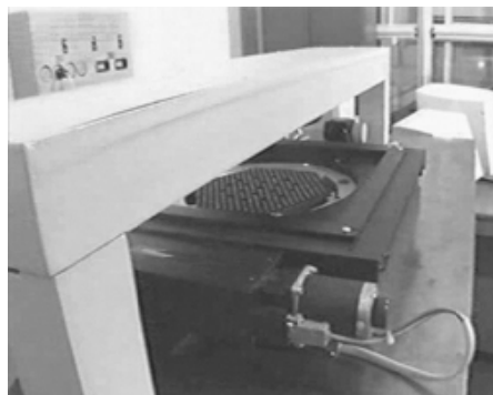
Рис. 1. Лазерная измерительная машина для высокопроизводительного бесконтактного контроля дистанционирующих решеток
