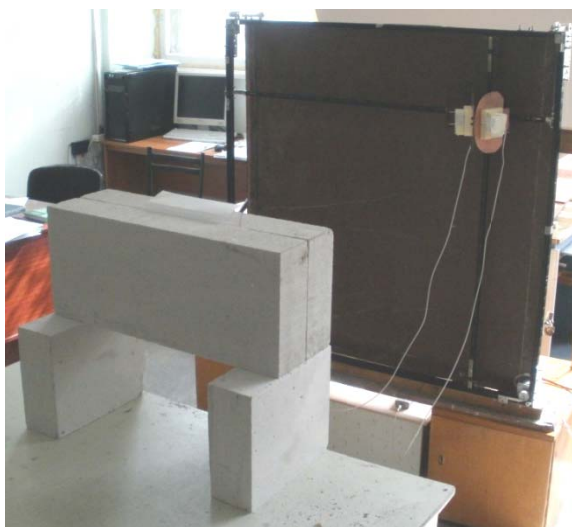
Рис. 4. Эксперимент по обнаружению тонкого металлического объекта в стене из пенобетона
