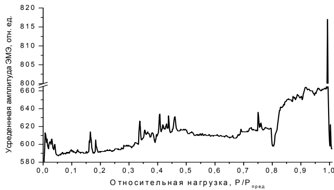
Рис. 3. Изменение усредненной амплитуды ЭМЭ в полосе частот 1 \div 100 кГц для образца вмещающей породы
