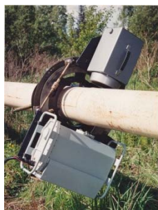
Рис. 5. Дефектоскопический комплекс в полевых условиях
