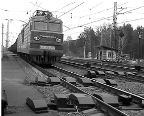
Рис. 11. Автоматическая лазерная система КОМПЛЕКС для бесконтактного контроля колесных пар на ходу поезда (Западно-Сибирская железная дорога, станция Барышево)
