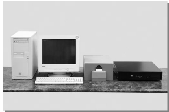
Рис. 5. Промышленная версия низкокогерентного профилометра ПРОФИЛЬ
