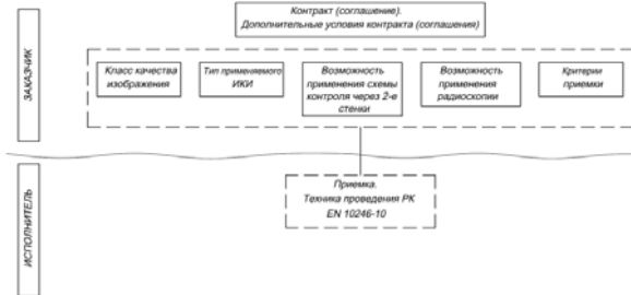
Рис.2. Блок-схема взаимосвязи условий контракта с требованиями стандарта EN по РК труб и трубопроводов
