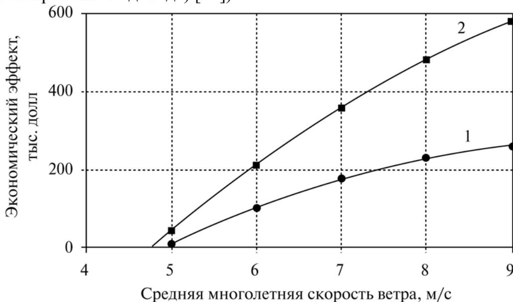
Рис. 1.8.4. Зависимость интегрального экономического эффекта от средней многолетней скорости ветра при цене на дизельное топливо 275 долл./т: 1 и 2 - без использования и с использованием «избыточной» электроэнергии на теплоснабжение [40]
