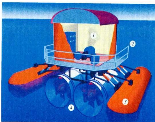
*Рис. 1.6.1. Общий вид наплавной микро-ГЭС: 1 – генератор, 2 – платформа, 3 – понтоны, 4 – диффузоры с гидротурбинами*
