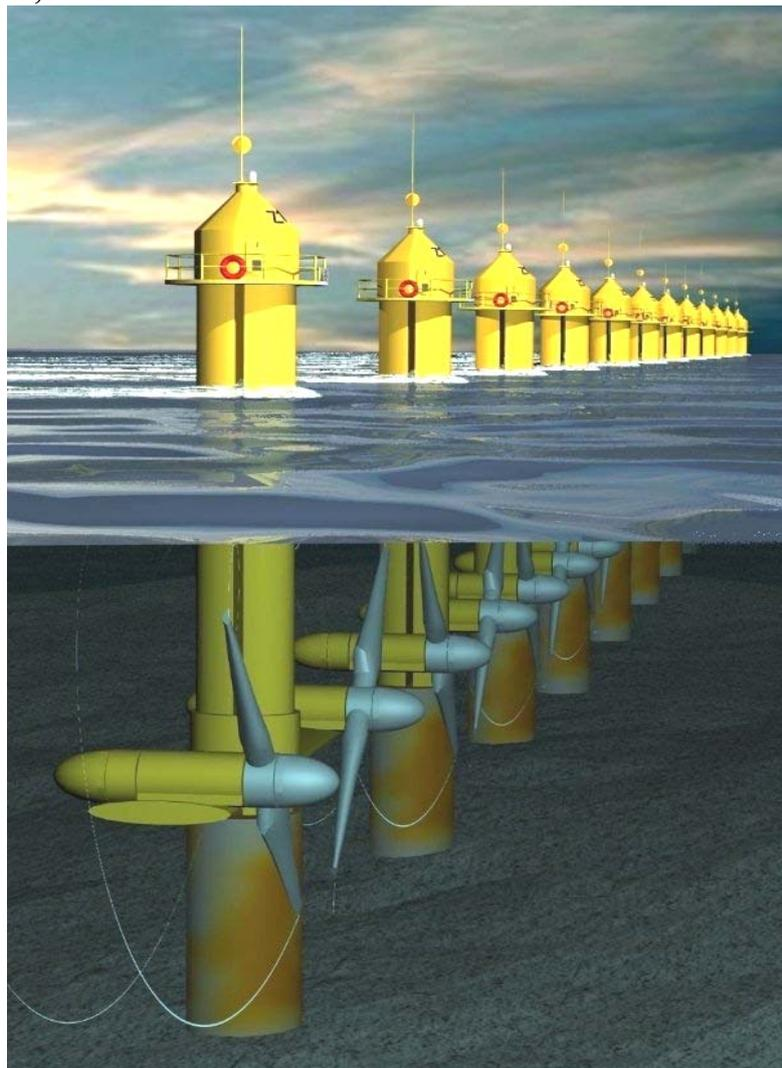
*Рис. 1.7.4. Внешний вид установок, использующих энергию морских (океанических) течений*
