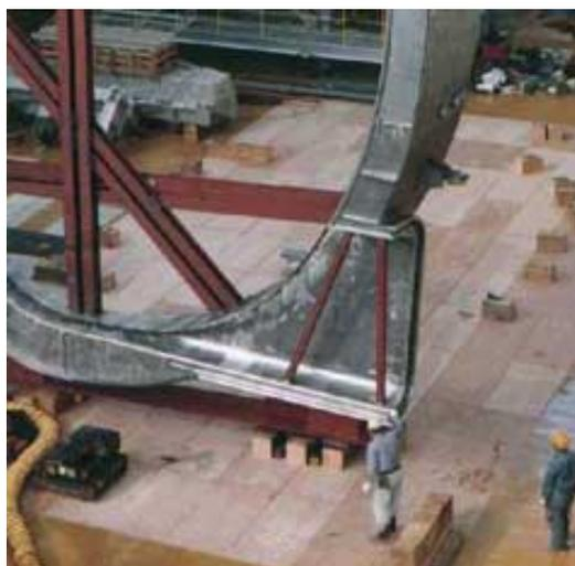
*Рис. 2.2.5. Фрагмент тороидального магнита ИТЭР*
