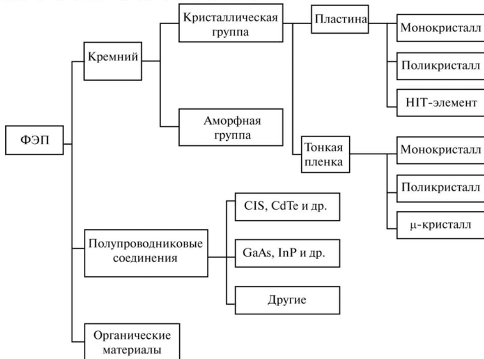
Рис. 1.4.1. Типы ФЭП для солнечных модулей [20]
