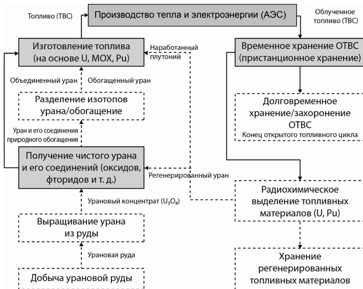
Рис. 2.8. Технологическая схема перемещения топливного материала внутри уран-плутониевого топливного цикла
