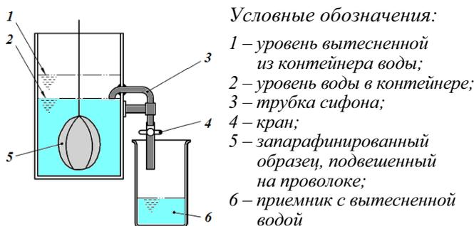
Рис. 4.9. Метод определения плотности вытеснением жидкости [130]
