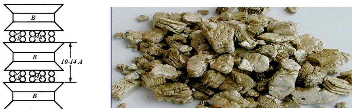
Рис. 2.13. Структура минерала вермикулита и его фотография
