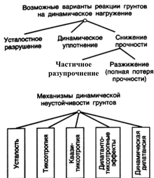
Рис. 8.76. Формы поведения грунтов при динамических нагрузках
