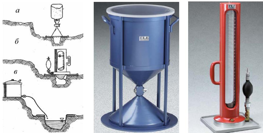
Рис. 4.10. Определение плотности грунтов методом замещения объема: а – с помощью полиэтилена, выстеленного в лунке; б – с помощью пескозагрузочного аппарата; в – аппаратом с резиновым баллоном
