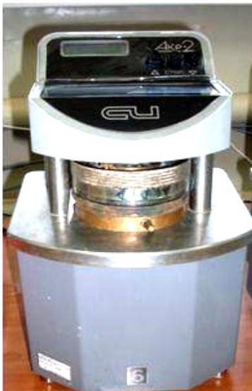
Рис. 8.16. АКР-2 (автоматический компрессионный релаксометр)
