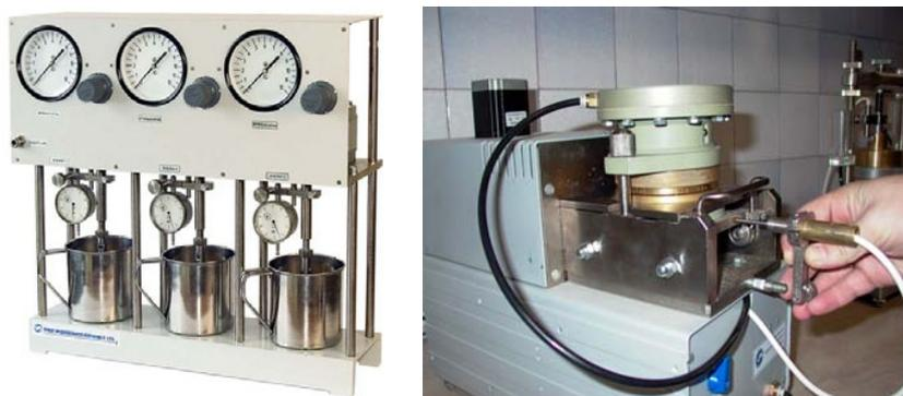
Рис. 8.36. Прибор предварительного уплотнения и срезной прибор с кинематическим нагружением ООО «НПП «Геотек»» [140]
