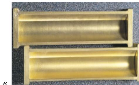
Рис. 5.11. Измерение образцов грунта при усадке:
