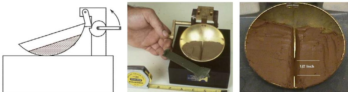
Рис. 4.4. Определения границы текучести ( $w_L$ ) грунта при помощи чашки Казагранде
