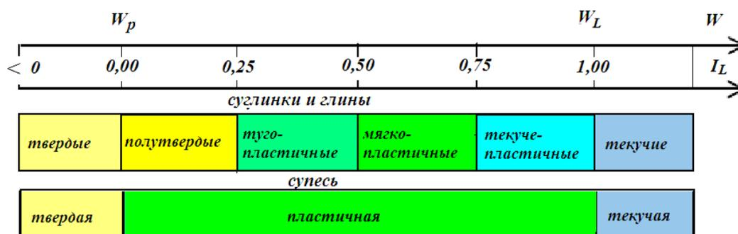
Рис. 4.2. Подразделение глинистых грунтов на разновидности по показателю  $I_L$
