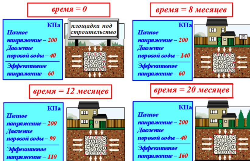
Рис. 8.6. Взаимосвязь напряжений и порового давления (кПа) при консолидации грунта в основании сооружения [136]
