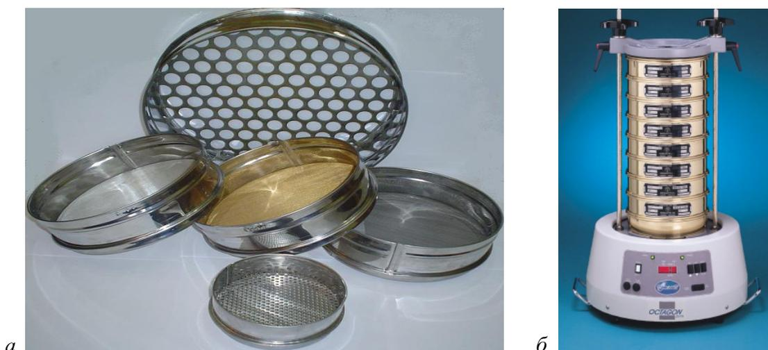
Рис. 2.18. Набор сит и машина для просеивания грунтов [136]
