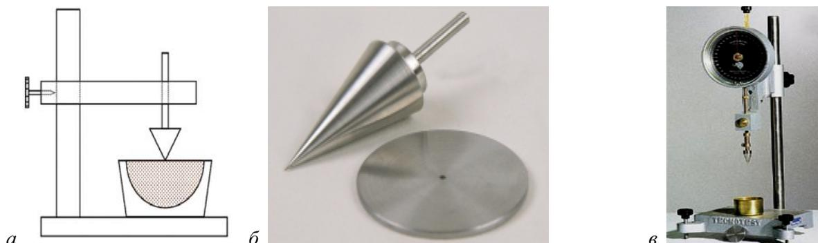
Рис. 4.5. Определения границы текучести ( $w_L$ ) падающим конусом:
