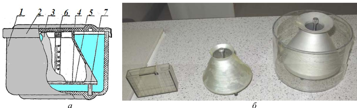
Рис. 8.44. Прибор для определения угла естественного откоса песчаных грунтов:
