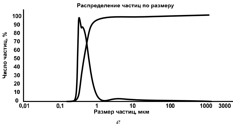
Рис. 3.56. Дисперсность дезагрегированных промежуточных продуктов горения смесей НП алюминия и вольфрама: а) образец 1; б) образец 3; в) образец 4; г) образец 5; д) образец 6; е) образец 30 (табл. 3.10)
