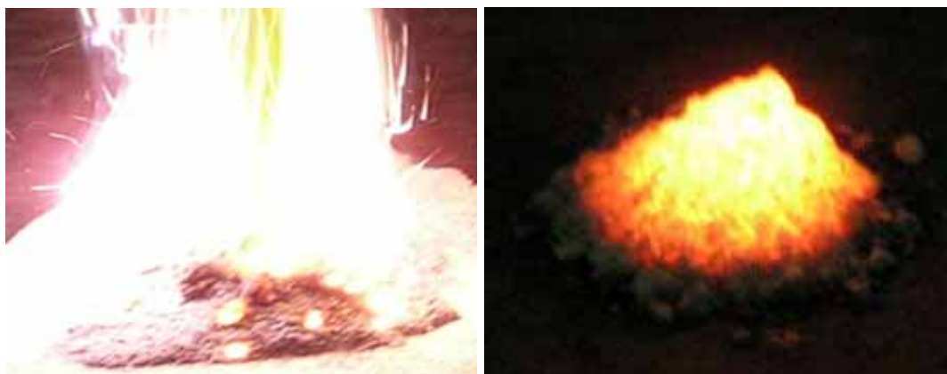
Рис. 3.90. Фотографии процесса горения грубодисперсного порошка циркония марки ПЦрК-3 в воздухе:
