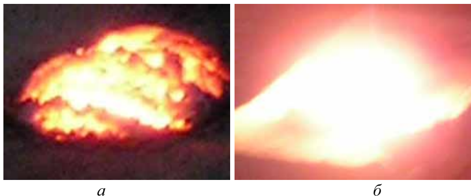
Рис. 3.6. Фотографии процесса горения порошка алюминия марки ПАП-2 в воздухе:
