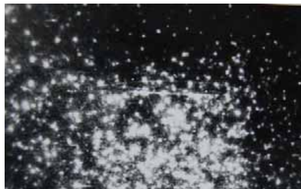
Рис. 7.43. Разряды по поверхности тонкого диэлектрика в одноимпульсном режиме
