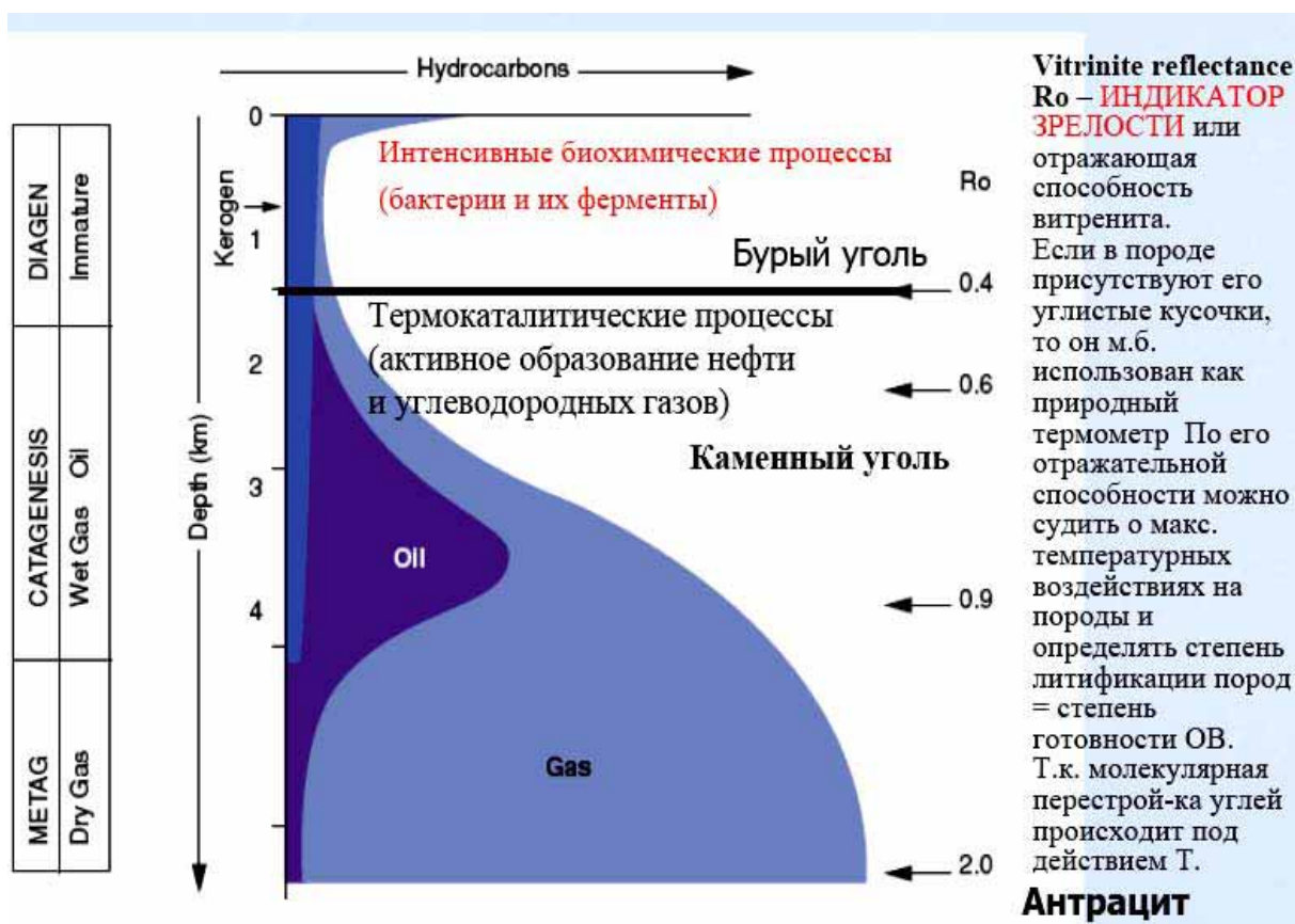
Рис. 3.1. Общая схема вертикальной зональности образования УВ в осадочных породах (по В.А. Соколову, Б. Тиссо, А.Э. Конторовичу)
