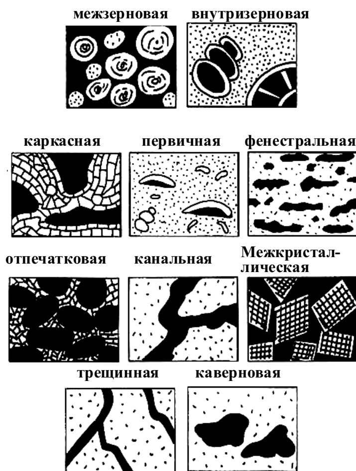
Рис. 5.17. Геологическая классификация пор и поровых систем в карбонатных породах (from North, 1985, after Choquette and Pray, 1970)
