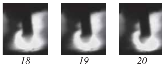
Рис. 14.8. Этап движения электродной проволоки
