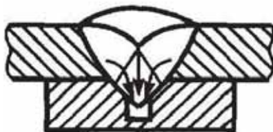
Рис. 17.1. Подкладка для сварки алюминиевых сплавов
