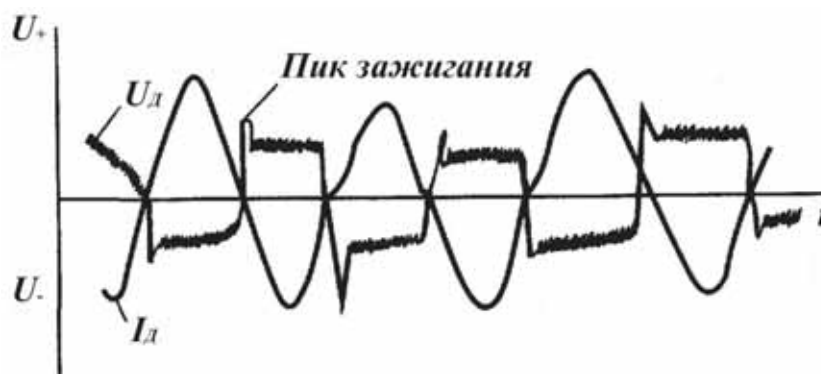
Рис. 2.4. Изменение полярности при горении дуги на переменном токе
