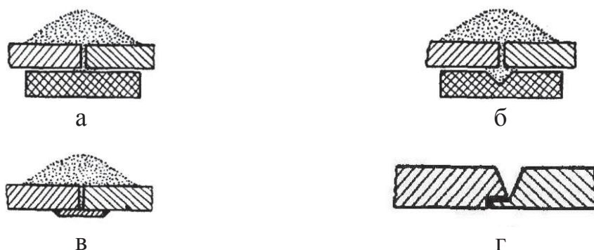
Рис. 13.7. Подкладки для сварки стыковых швов: а – медные; б – флюсомедные; в – остающиеся; г – полка в одном из листов
