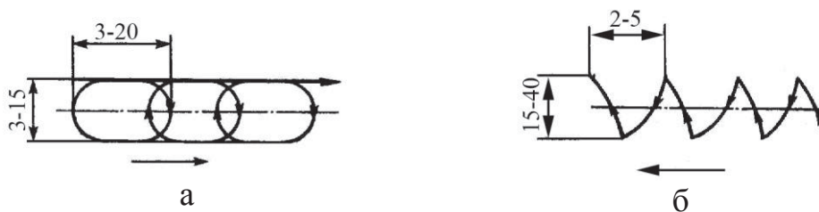
Рис. 15.4. Колебательные движения электрода при сварке порошковой проволокой: а – по спирали; б – змейкой
