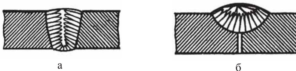
Рис. 5.3. Схема кристаллизации расплава в зависимости от формы сварочной ванны: а – узкая сварочная ванна с глубоким проплавлением; б – широкая сварочная ванна
