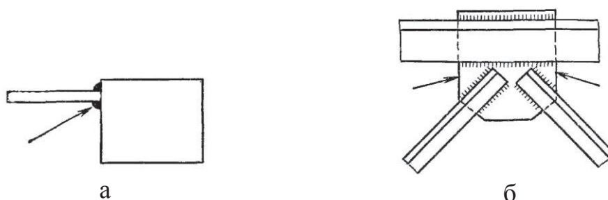
Рис. 19.1. Примеры нерациональных конструкций, вызывающих концентрацию напряжений и разрушение при низкой температуре: а – приварка тонкой полосы; б – расстояние между швами (стрелками показана концентрация напряжений)
