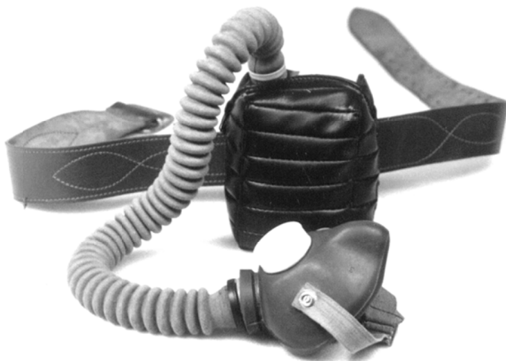
Рис. 5.22. Устройство очистки и подачи воздуха в зону дыхания сварщика «Шмель-40»
