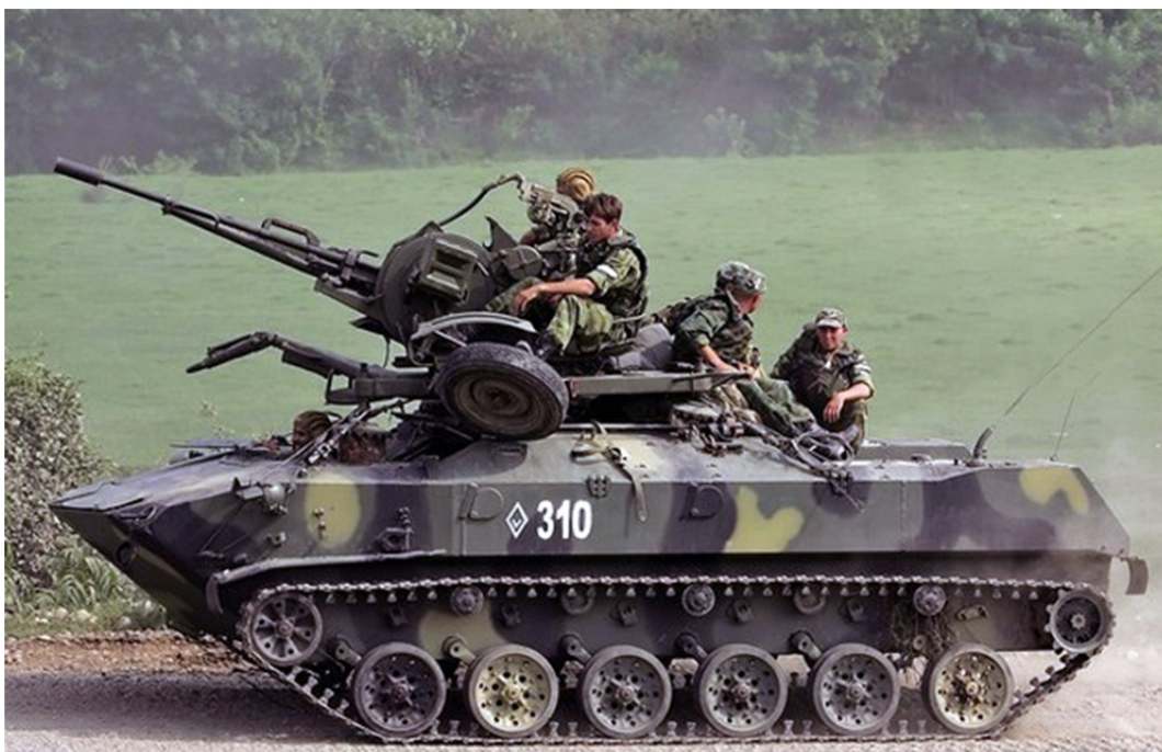
Рис. 1.2. 23-мм спаренная установка на броне БМД-1
