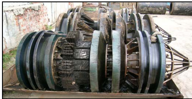
Рис. 5.29. Очистной скребок типа СКР-3
