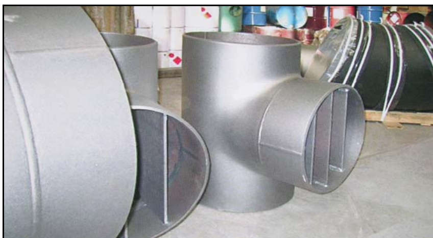
Рис. 5.36. Тройники, оборудованные предохранительными решетками
