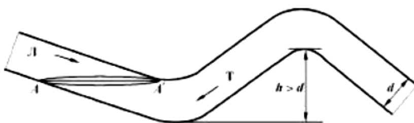
Рис. 3.21. Схема образования гидрозатвора в колене нефтепровода
