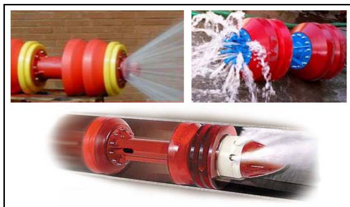
Рис. 5.34. Перепуск жидкости через байпас-отверстия способствует размытию отложений перед скребком
