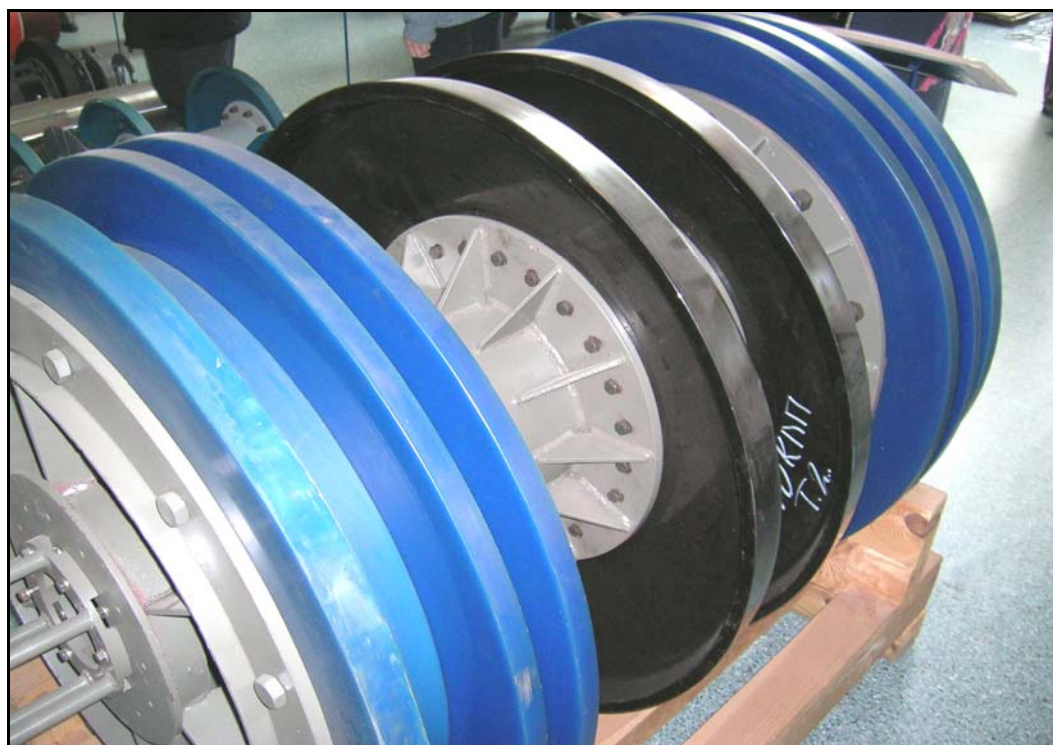
Рис. 5.26. Очистной скребок типа СКР-1
