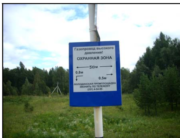
Рис. 5.11. Предупреждающие знаки на трассе магистрального нефтепровода и газопровода с указанием границ охранной зоны
