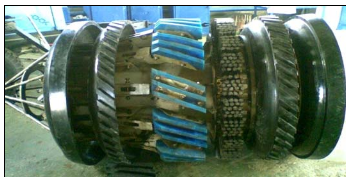
Рис. 5.30. Очистной скребок типа СКР-4
