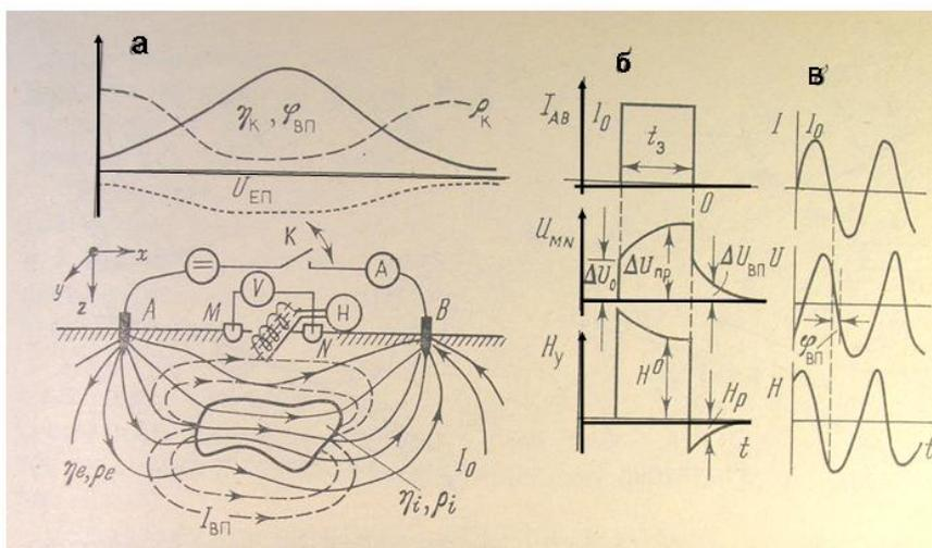
Рис.4.27. Установки для изучения вызванной поляризации (а) электронно проводящего рудного тела при нестационарном поле (б) и при гармоническом поле (в).
