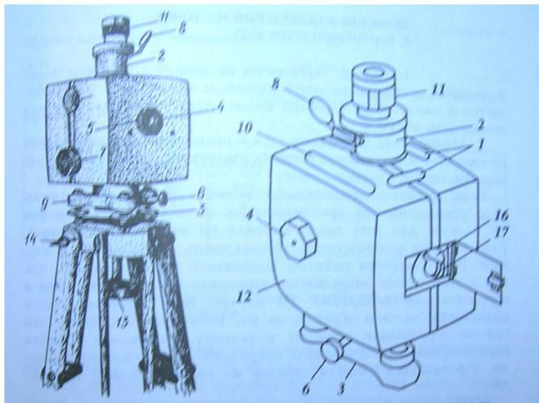
Рис. 3.14. Общий вид магнитометра М - 27М.
