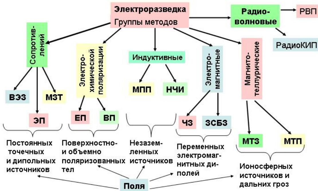
Рис. 4.2. Классификация методов электроразведки по специфике изучаемых полей.
