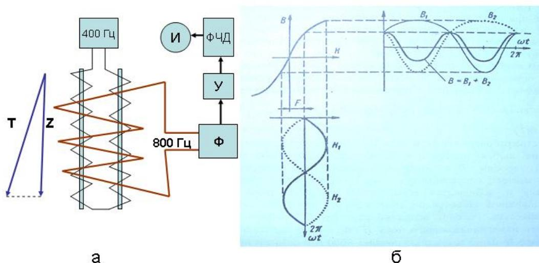
Рис. 3.15. Принцип действия феррозондового магнитометра типа второй гармоники.
