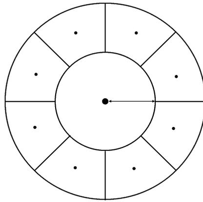
Рис. 2.27 Палетка для расчета поправки за рельеф
