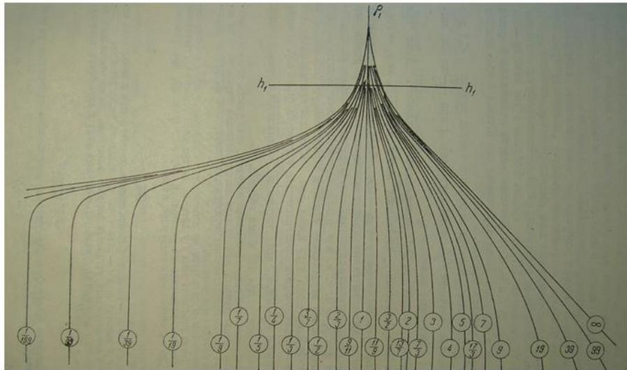
Рис. 4.19. Вид палетки  $\rho_2$  для количественной интерпретации двухслойных кривых ВЭЗ.
