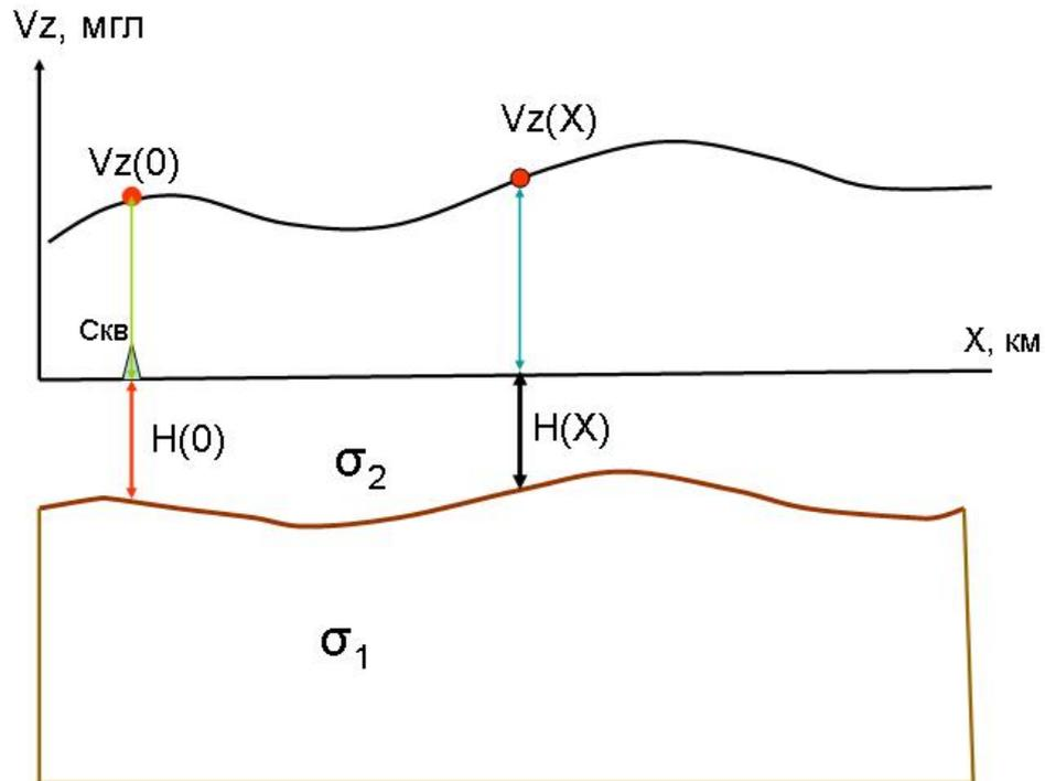
Рис. 2.35. Построение контактной поверхности по данным гравиразведки
