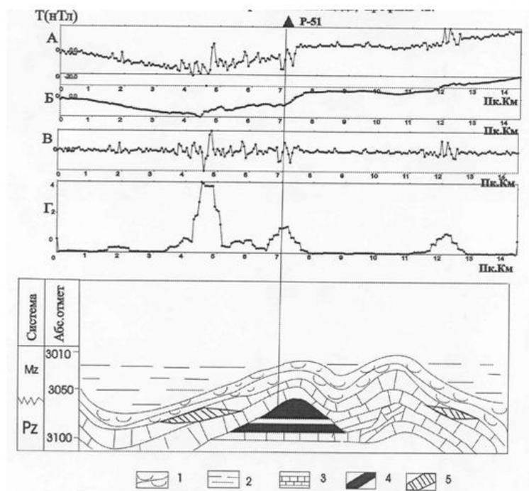
Рис. 7.11. Структура магнитного поля и его трансформант над Арчинским газоконденсатным месторождением (по В.П. Меркулову, 2002): А, Б, В - соответственно наблюдаемое, осредненное и остаточное магнитное поле, Г – дисперсия магнитного поля; 1 – кора выветривания, 2 – породы осадочного чехла, 3 – карбонатные породы фундамента, 4 – залежь газоконденсата, 5 – прогнозная залежь.
