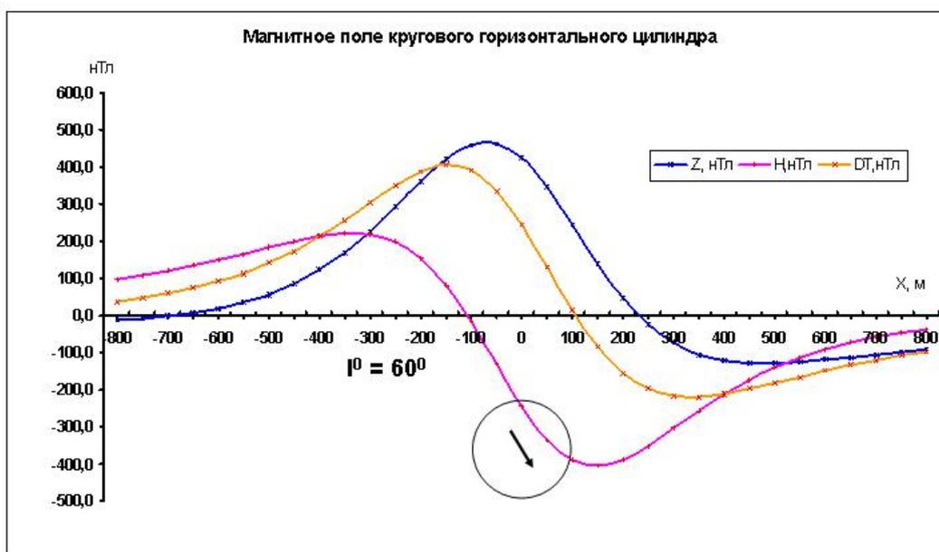
Рис. 3.23. Графики  $Z$ ,  $H$  и  $\Delta T$  для кругового горизонтального цилиндра при наклонном намагничении под углом  $60^0$ .
