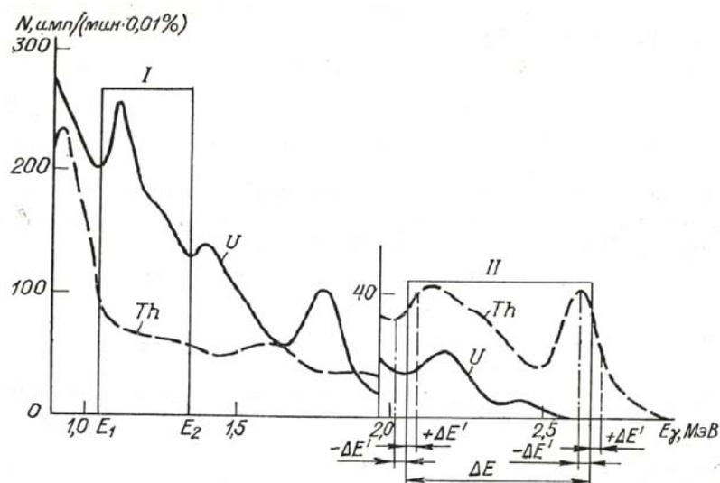
Рис 5.11. Выбор энергетических окон двухканального  $\gamma$ -спектрометра. Кристалл NaI (Tl). Ширина окна  $\Delta E_0 = 30$  кэВ. Окна, МэВ: I - 1,05 – 1,35, II - 2,05 – 2,65 ( по Г.Ф. Новикову, 1989).
