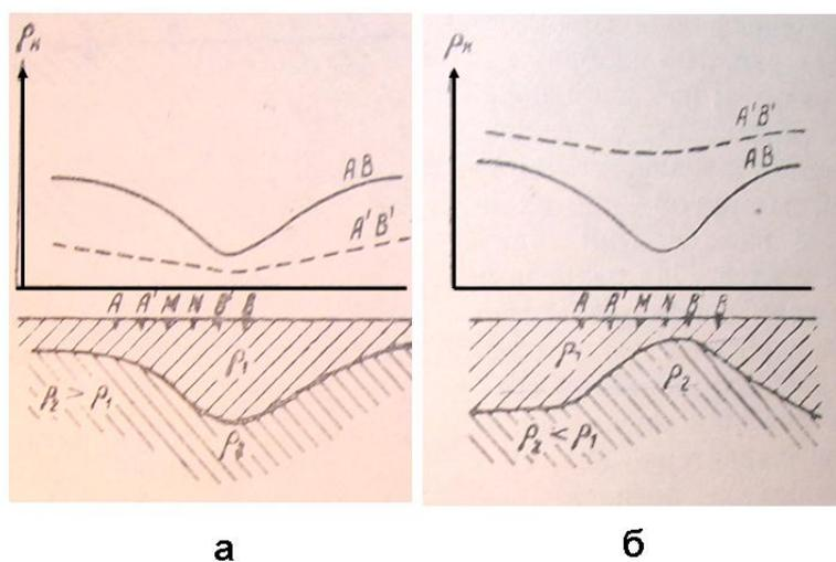
Рис. 4.12. Графики двухразносного профилирования антиклиналью и синклиналью при разных соотношениях сопротивлений выше- и нижележащей толщ:
