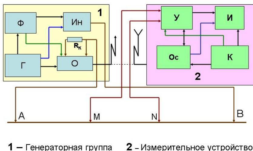
Рис. 4.28. Обобщенная блок-схема аппаратуры для измерения ВП в гармонически меняющихся полях (по В. П. Мельникову, Б. И. Геннадиннику и др.)
