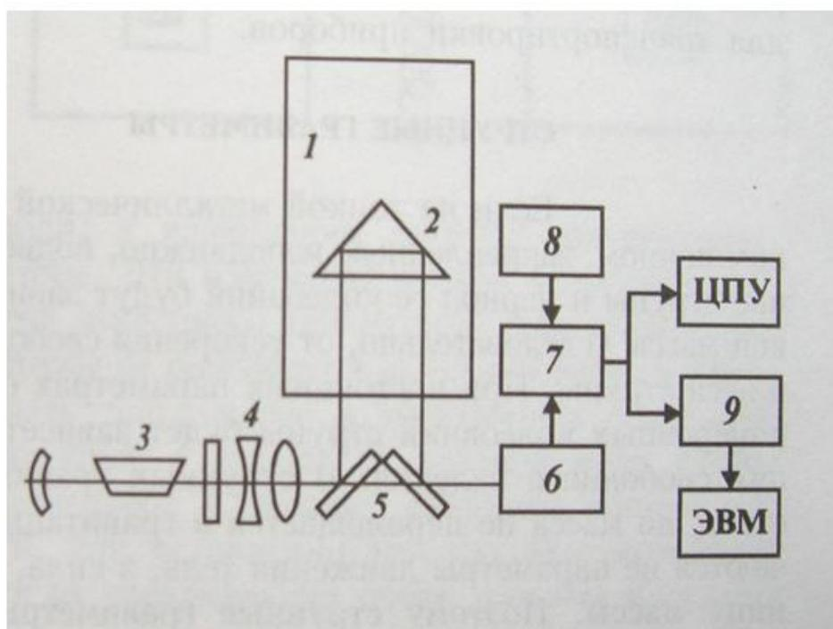
1 – вакуумная камера, 2 – уголкового отражатель, 3 – лазер, 4 – коллиматор, 5 – полупрозрачные зеркала, 6 – фотоумножитель, 7 – счетный блок, 8 – генератор меток времени, 9 – перфоратор, ЦПУ – цифropечатающее устройство.
