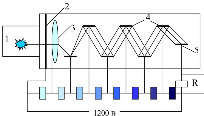
Рис. 5.7. Принципиальная схема сцинтилляционного счётчика.
