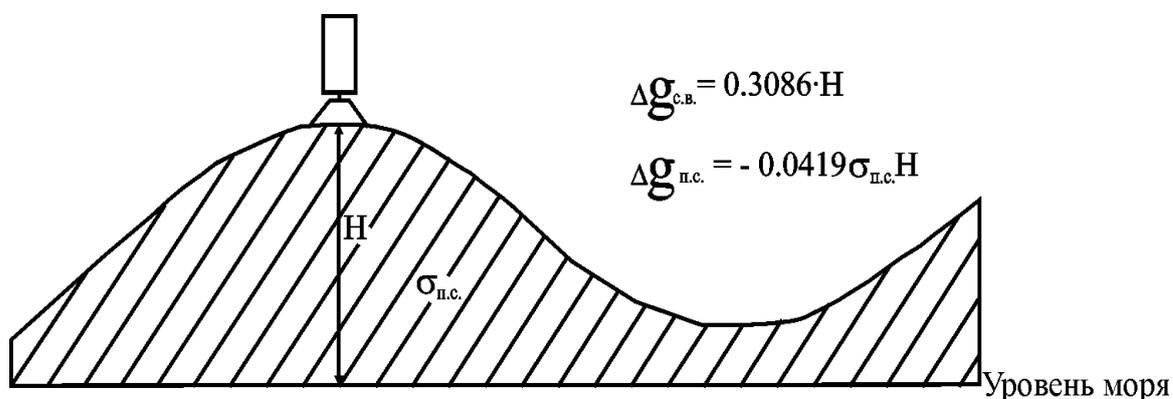
Рис. 2.24. Поправки за высоту точки стояния и плотность пород промежуточного слоя
