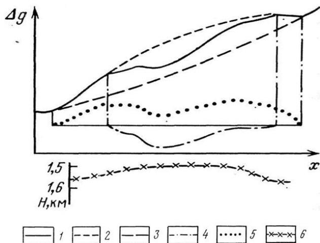
*Рис.7.3 Структурно-гравиметрический профиль Бондюжского поднятия Татари (по З. М. Слепаку, 1989): 1 – наблюдаемая аномалия силы тяжести, 2 – восстановленный локальный максимум, 3 – региональный фон, 4 – локальный минимум, 5 – локальный максимум, 6 - поверхность кристаллического фундамента.*
