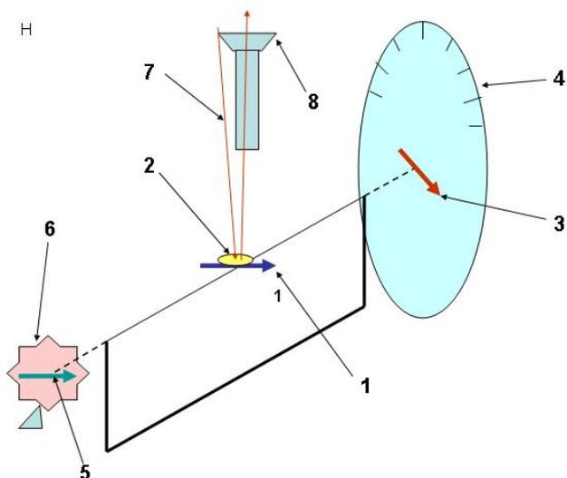
*Рис.3.13. Принципиальное устройство оптико-механического магнитометра М – 27М*
