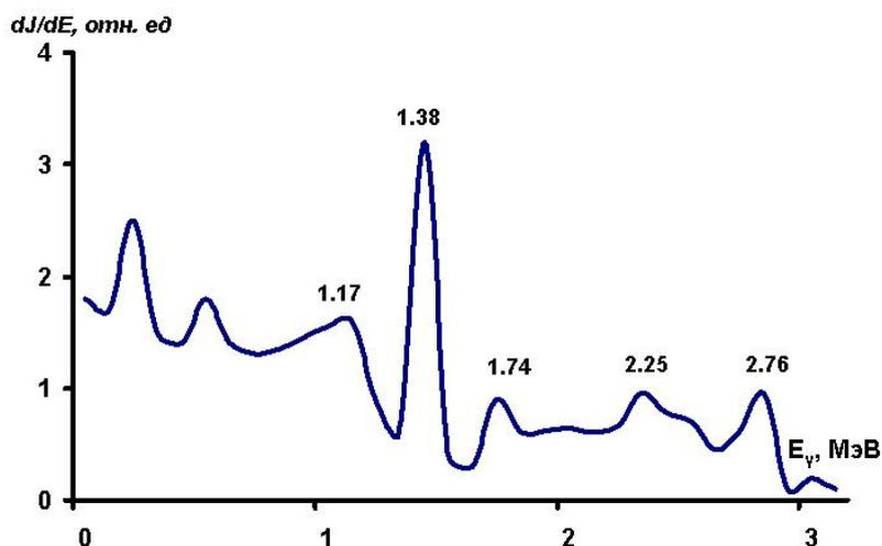
Рис. 5.9. Аппаратурный спектр  $\gamma$ -излучения  $^{24}\text{Na}$ , содержащий линии с энергией 1,38 и 2,76 МэВ.
