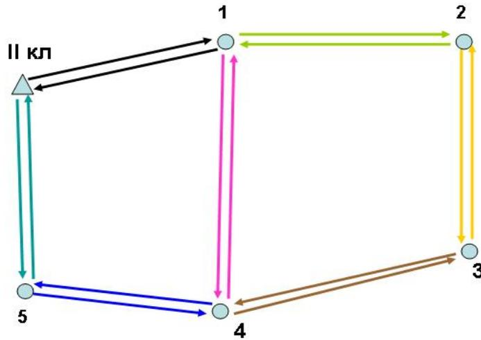
Рис. 2.22. Полигональная система создания опорной сети.
