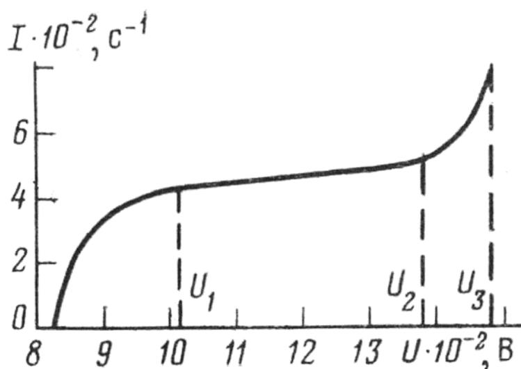
Рис. 5.6. Счетная характеристика счетчиков Гейгера – Мюллера.
