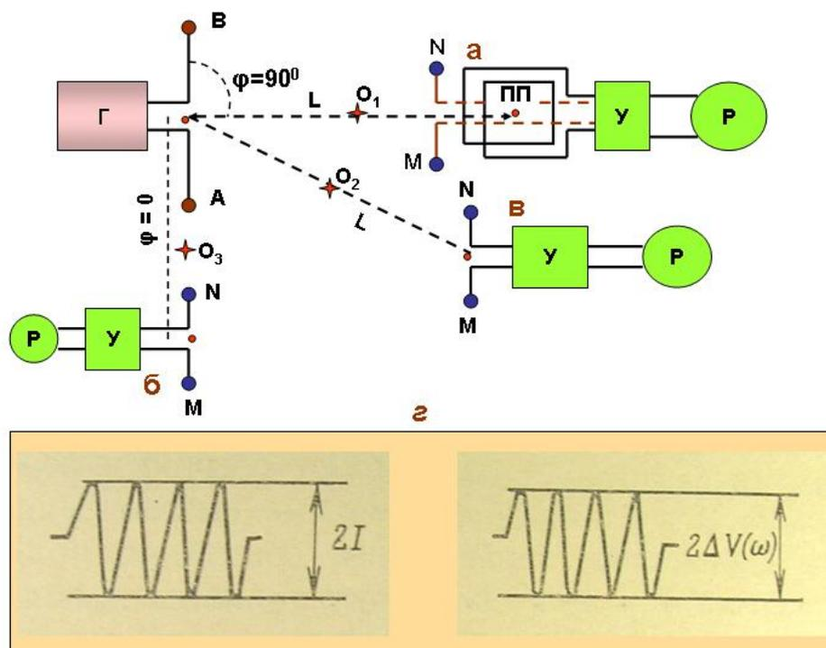
Рис. 4.29. Установки, применяемые в методе частотного зондирования: а — экваториальная ( $\varphi = 90^\circ$ ), б — осевая ( $\varphi = 0^\circ$ ), в — азимутальная, г — форма импульса тока и регистрируемого сигнала. Обозначения: Г — генератор, ПП — приемная петля, У — усилитель, Р — регистратор,  $O_1, O_2, O_3$  — центры (точки записи) установок.
