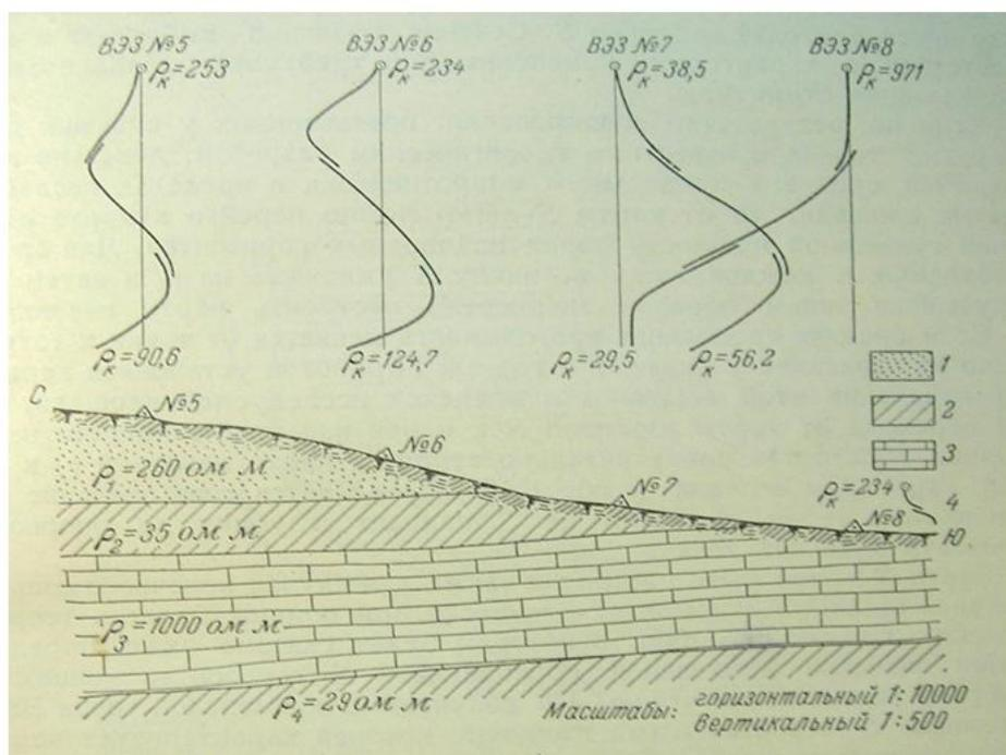
Рис.4.18. Кривые ВЭЗ и схематический геологический разрез по профилю. Обозначения: 1 – пески, 2 – глины, 3 – известняки, 4 – кривая ВЭЗ и значения  $\rho_k$  на начальном и конечном разносах (по Ю. В. Якубовскому и Л. Л. Ляхову).
