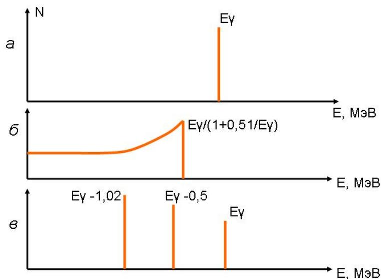
*Рис. 5.8. Упрощенная схема распределения энергии вторичных электронов в люминофоре при: а – фотоэффекте, б – комптоновском рассеянии, в – образовании пар;  $N$  - число импульсов,  $E$  – энергия вторичных электронов.*
