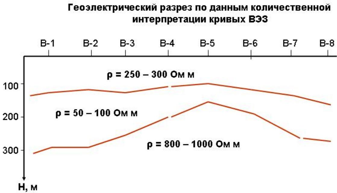
Рис. 4.20. Геоэлектрический разрез, построенный по результатам количественной интерпретации данных ВЭЗ.
