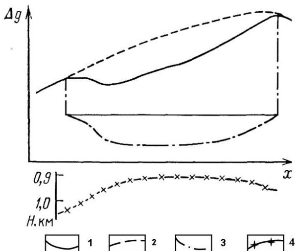
Рис. 7.2. Структурно-гравиметрический профиль Ямашинского поднятия (По З. М. Слепаку, 1989): 1- наблюдаемая аномалия силы тяжести, 2 – региональный фон, 3 – локальный минимум силы тяжести, 4 – поверхность отложений турнейского яруса.
