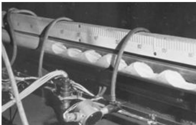
*Рис. 4.58. состояние малосвязного сыпучего материала (глинозем) после воздействия волны разрежения*
