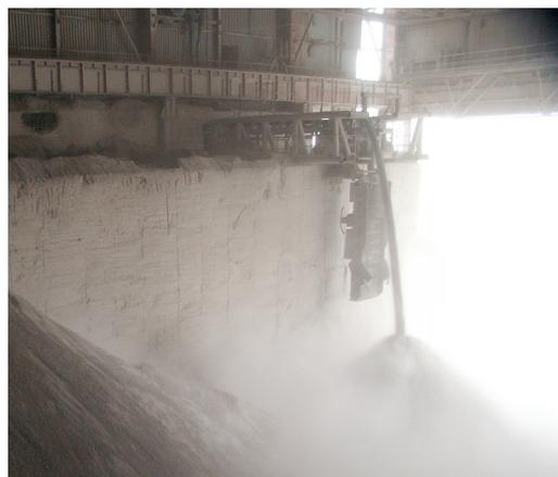
*Рис. 3.13 Выделение пыли при ссыпании материала из конвейера в склад*
