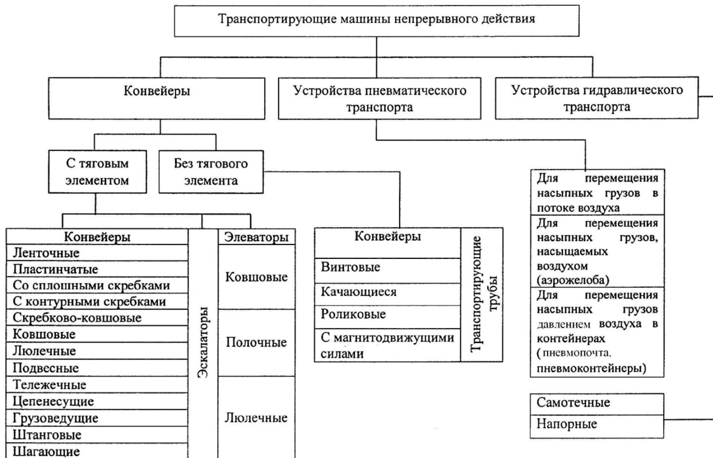
Рис. П.1. Классификация транспортирующих машин непрерывного действия
