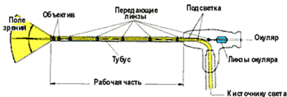
Рис. 4.3. Жесткий эндоскоп на основе линзовой оптики
