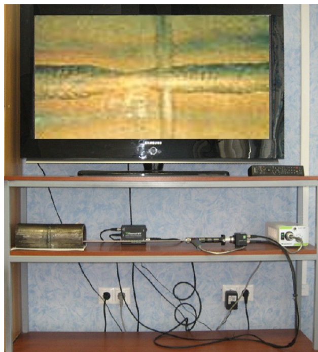
Рис. 4.17. Видеосистема с жестким эндоскопом с качающейся призмой
