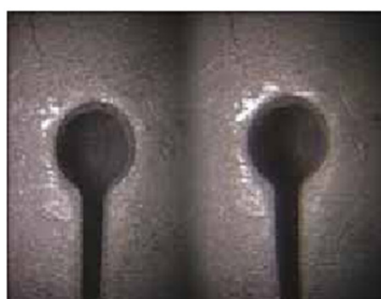
Рис. 7.10. Пример хороших условий для стереоскопического измерения
