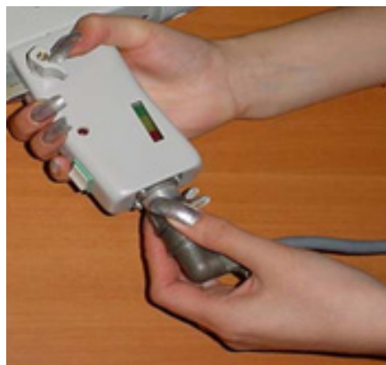
Рис. 1.15. Подключение эндоскопа к аккумуляторной батарее
