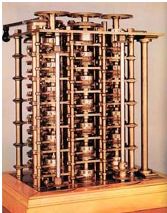
Разностная машина, сконструированная по записям Бэббиджа через сто лет после его смерти
