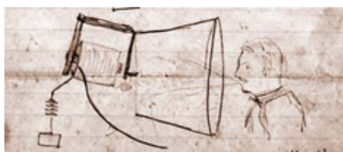
Набросок устройства телефонного аппарата, сделанный Беллом
