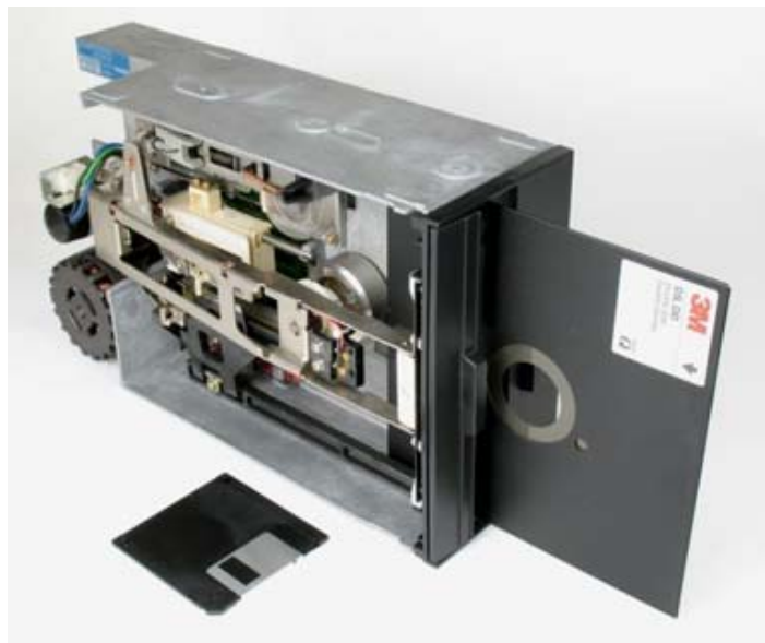
Накопитель на гибком магнитном диске (сравнение 8-дюймовой дискеты и дискеты 3,5 дюйма)
