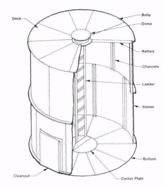
Deck - крыша резервуара Cleanout - очистное отверстие Bolt - болт Dome - куполообразная крыша Rafter - балка / стропила Channel - канал Ladder - висячая лестница Stave - планка Bottom - днище резервуара Center plate - плита
