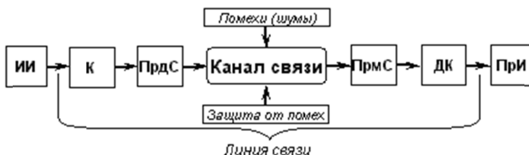
Рис. 2.1. Общая схема передачи информации (ИИ – источник информации, К – кодер, ПрдС – передатчик сообщения, ПрС – приемник сообщения, ДК – декодер, При – приемник информации)
