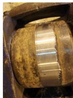
*Рис. 6. Восстановленный ролик*
