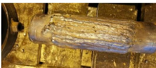
*Рис. 7. Восстановление пальца наплавкой*
