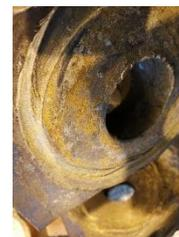
*Рис. 4. Изношенный корпус роликового вкладыша*
