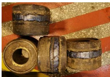
*Рис. 5. Реставрация роликов с помощью наплавки*
