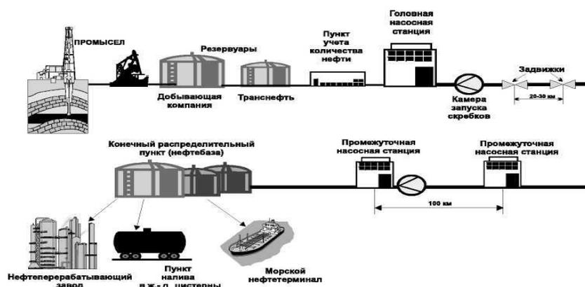
Рис.2 Технологическая схема НПС
