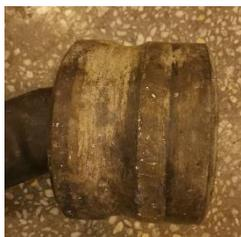
*Рис. 2. Изношенный ролик*
