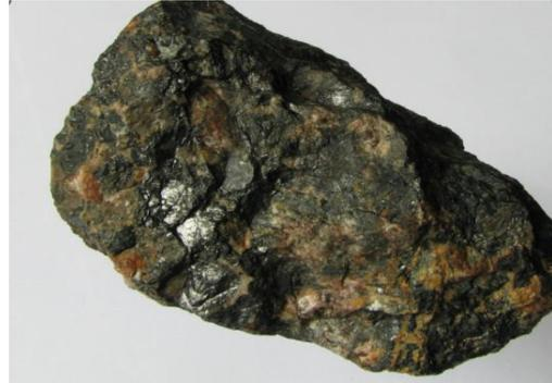
**Рис. 2 Коффинит и урановая смолка в образце из шахты [3]**
