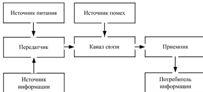
Рис. Общая схема телеметрической системы
