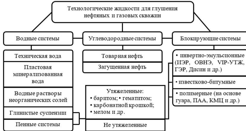
Рис. 1 Основные типы жидкостей глушения скважин
