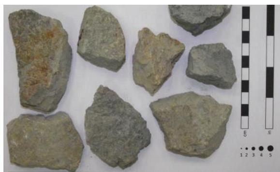
Рис. 2 Фотографии проб рядовой и богатой сульфидной руд
