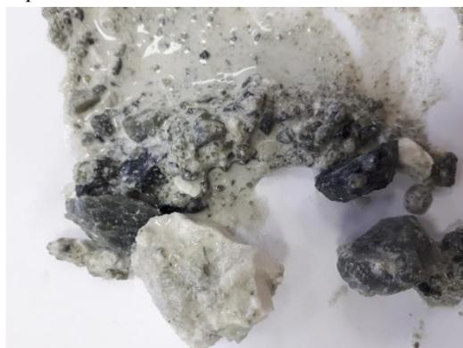
Рис. 1 Фотография образца после контакта с водой
