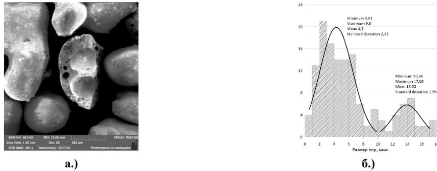
Рис. 1 Гранулы с содержанием глины в количестве 15% от массы исходного состава, обожженные при температуре 1050°C с выдержкой в течении 8 мин.: а.) микроструктура; б.) гистограмма распределения пор по размерам.
