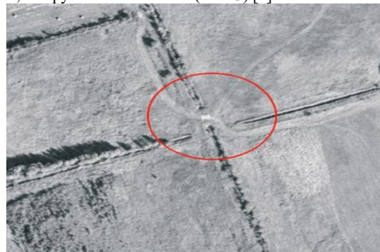
Рис. 2 Перекрытие каналов осушительной сети земляными дамбами по материалам АФС
