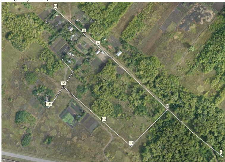
Рис.3. Схема расположения сооружения опор ЛЭП, созданная в Metashape
