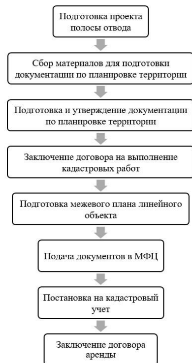
Рис. 1. Процедура формирования земельных участков для линейных объектов нефтегазового комплекса
