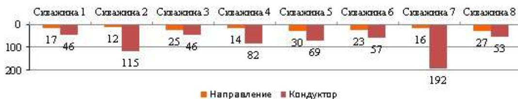
Рис. 1. Интервалы глубин вскрытия поглощения промывочной жидкости
