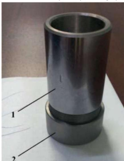
Рис. 1. Цилиндрический стакан для исследований: 1 – стакан, 2 – крышка-зажим
