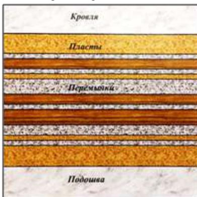
Рис. 1. Схема задачи многослойной неизо термической фильтрации
