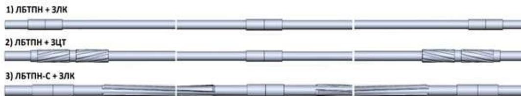
**Рис. 2. Варианты компоновок буровой колонны**
