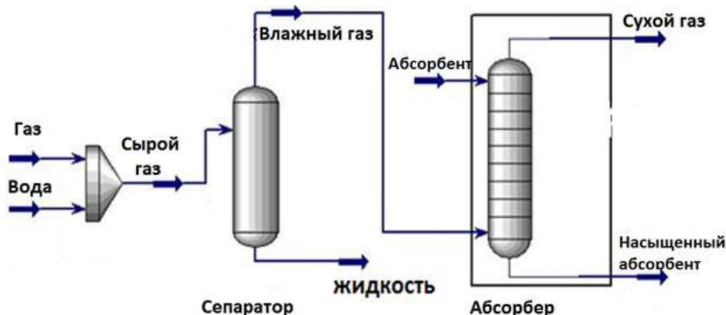
Рис. 2. Моделирующая схема абсорбционной осушки газа
