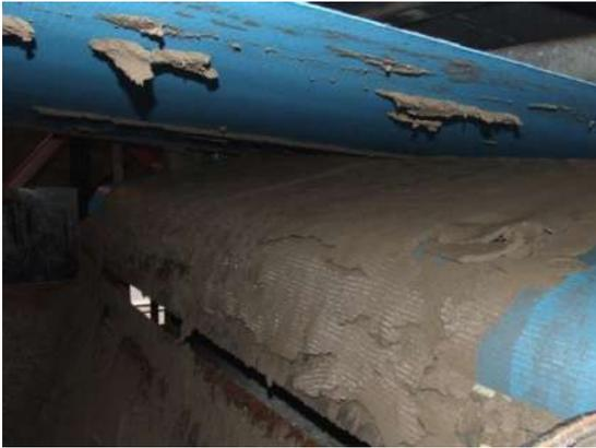
Выбор конкретного типа оборудования для гранулирования продукта глинистого минерализованного затруднен из-за формирования кусков размером от 1 до 5 см при «срезании» пласта с фильтроткани ленточного фильтра (рис. 2) и высокой влажности продукта глинистого минерализованного.
