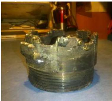
Рис. 1. Коронка с расширителем местного изготовления
