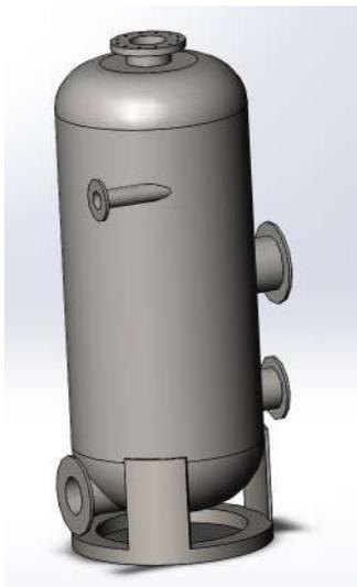
Существуют различные способы дегазации бурового раствора, при содержании свободного газа более 20% по объему, а так же при бурении с герметизированным устьем применяют газовые сепараторы [2].
