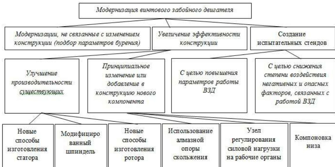
*Рис. 1. Классификация способов модернизации винтовых забойных двигателей*
