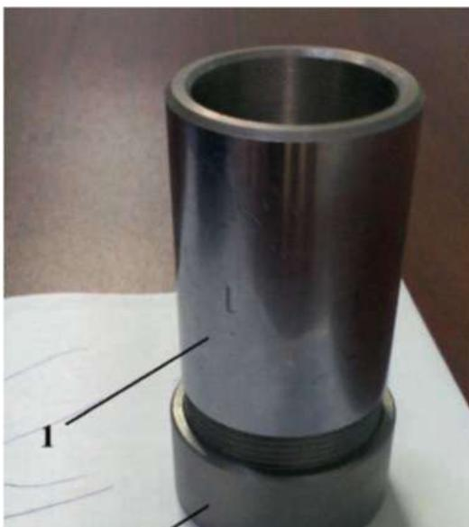
*Рис. 1. Цилиндрический стакан для исследований: 1 – стакан, 2 – крышка-зажим*
