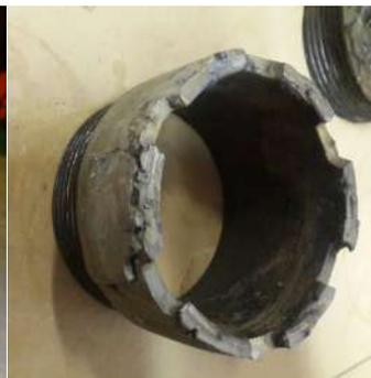
Рис. 2. Износ твердосплавной коронки
