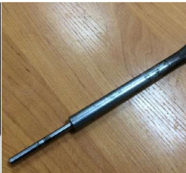
*Рис. 2. Инструмент для абразивного воздействия на образец*
