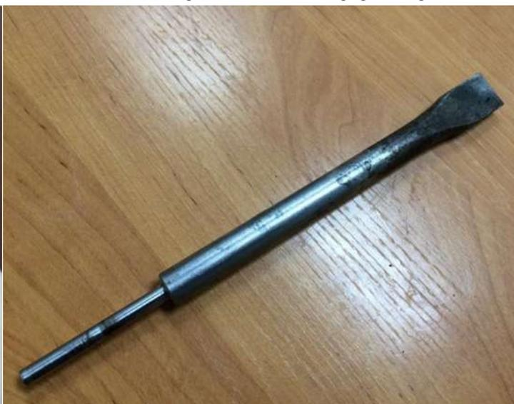
Рис. 2. Инструмент для абразивного воздействия на образец
