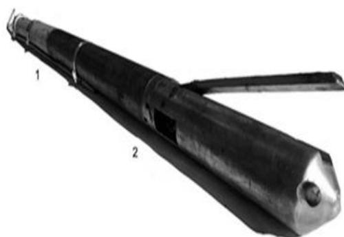
*Рис. 1. Скважинный дебалансный вибросейсмический источник*
