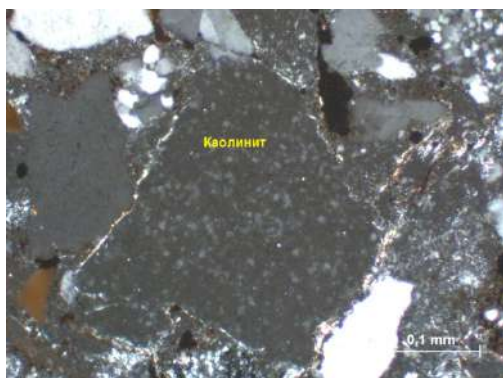
Рис. 1. Полное замещение агрегатами каолинита зерна полевого шпата. Образец 6467, глубина 2073 м. Николи +
