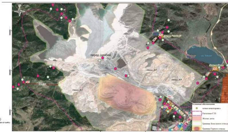
Рис. 1. Схема отбора проб снежного покрова на территории ООО «Сорский ГОК» и в зоне его влияния (на схеме точки красного цвета – точки отбора проб почв в 2015 г.; точки зеленоватого цвета с номерами – точки отбора проб снежного покрова в 2016 г.)
