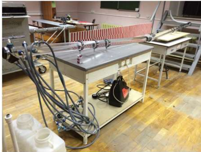
Рис. 1. Стенд горизонтального участка скважины
