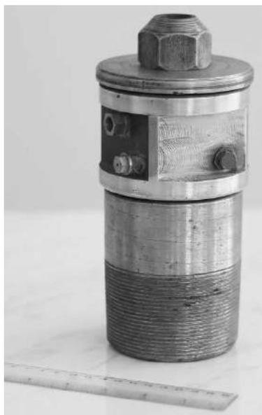
**Рис.2** Натурный образец – роторное устройство, диаметр 100 мм
