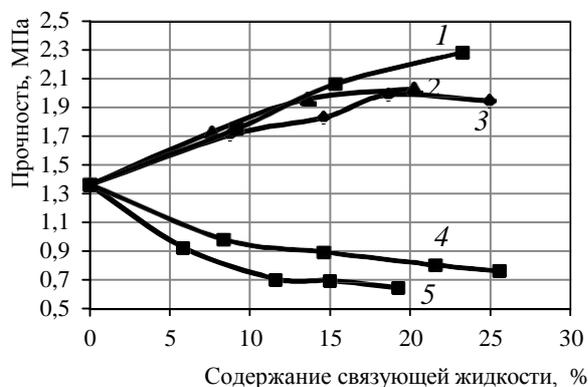
Рис. 1. Зависимость прочности таблеток от содержания связующей жидкости:
