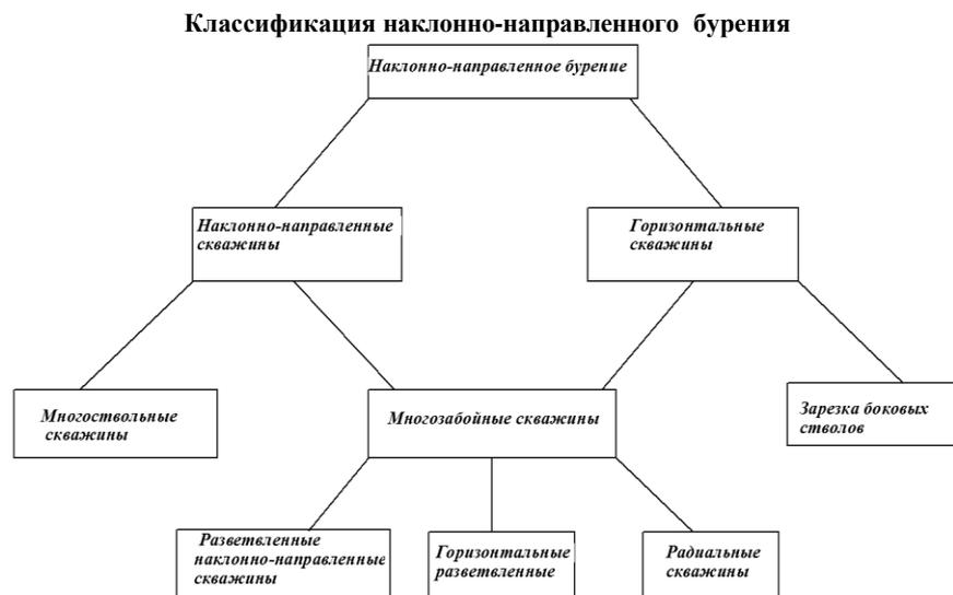
**Рис.1** Классификация наклонно-направленного бурения
