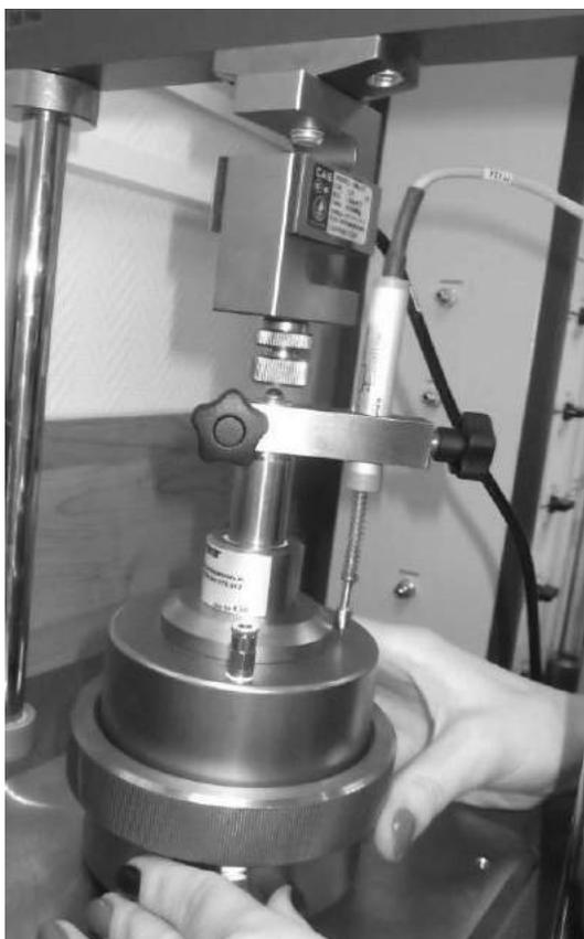
**Рис. 1. Компрессионные испытания**
