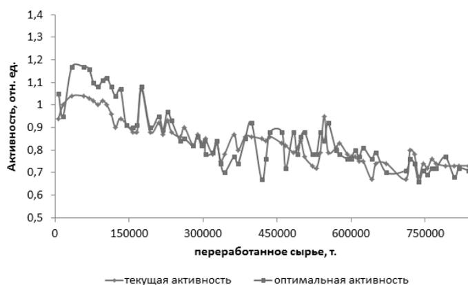
Рис. 1 Мониторинг работы промышленной установки каталитического риформинга бензинов
