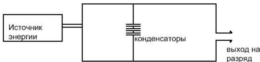
Рис.1 Схема установки плазменно-импульсного воздействия
