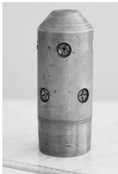
**Рис.3** Натурный образец – статическое устройство, диаметр 89 мм
