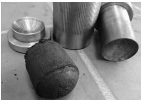
*Рис. Образец брикетированного топлива*
