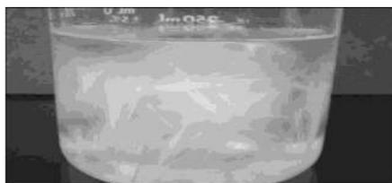
Рисунок 2. Растворенный в воде волоконный наполнитель CemNET
