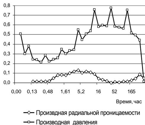
Рис.3 Диагностические графики выделения потоков скважины №1
