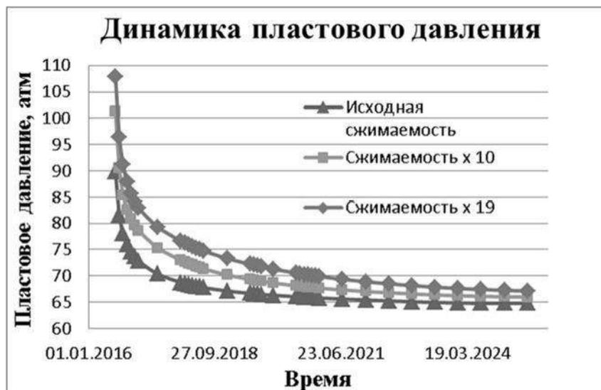
Рис.2 Результаты сравнения расчетов с разной сжимаемостью
