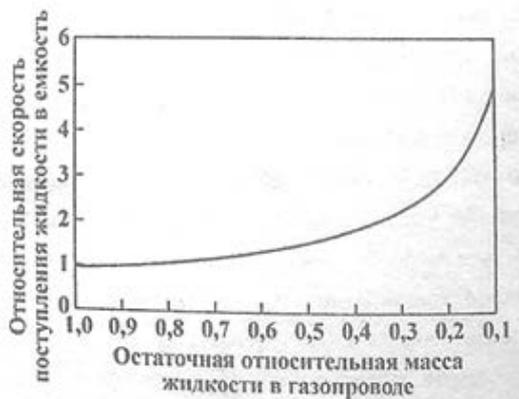
Рис. 2. Изменение скорости жидкости при её поступлении в емкость: остаточная относительная масса жидкости в газопроводе  $M_L = M_{Li}/M_L$ ; относительная скорость поступления жидкости в емкость  $W_L = W_{Li}/W_L$ ; Где:  $M_{Li}$  – масса жидкости, которая остаётся в трубопроводе;  $M_L$  – исходная масса жидкости;  $W_{Li}$  – скорость жидкости, поступающей в ёмкость;  $W_L$  – начальная скорость жидкости, равная её скорости в трубопроводе. Рисунок из [3]
