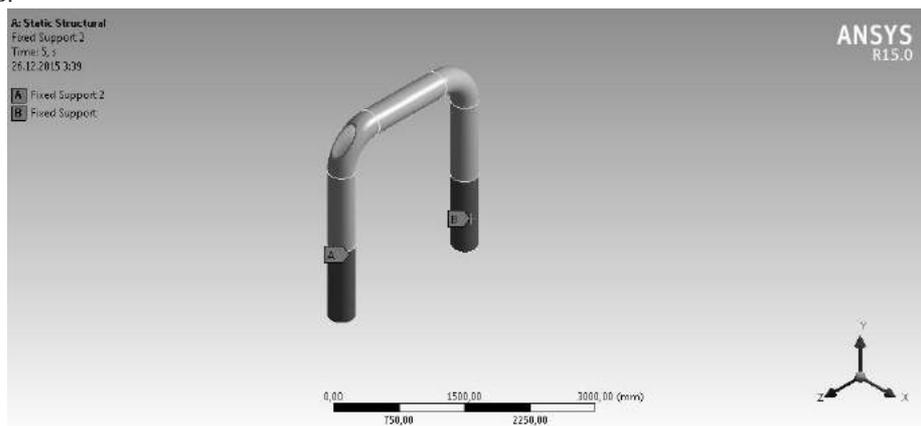
Рис. 3. Жесткое закрепление на концах участка трубопровода
