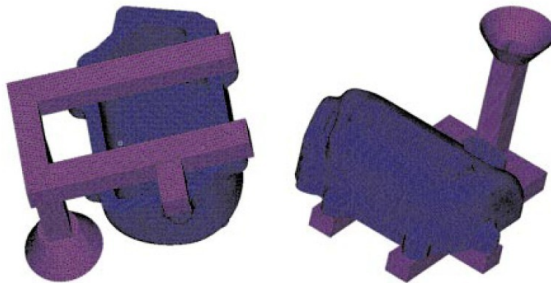
Рис. 1. 3D-модель крышки ресивера с литниковой системой
