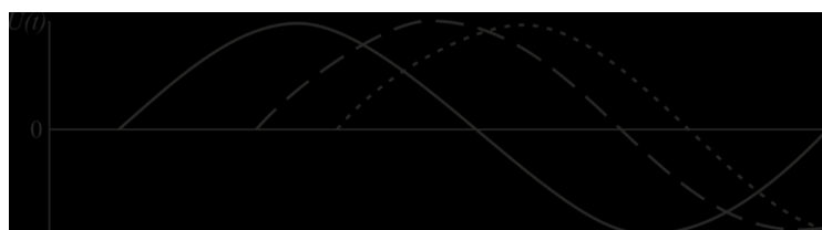
Рис. 2. Разница во времени прихода акустических лучей, обусловленная волноводным распределением
