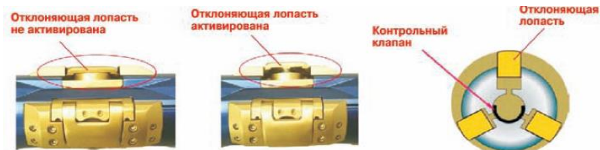
Рис.3 Схема отклоняющего блока
