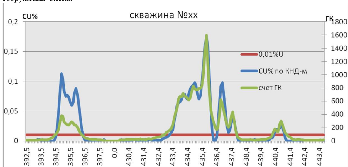
Рис.3. Результаты проведения ГК и КНД-м по рудному интервалу (данные АО «Волковгеология»).
