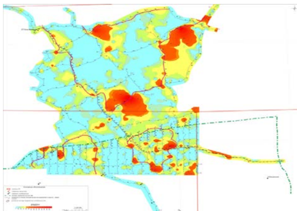
Рис. 3. Схема распределения повышенных значений плотности потока радона, установленных в подпочвенных отложениях на изучаемом участке, отождествляемыми с наиболее проницаемыми зонами в чехле осадочных пород
