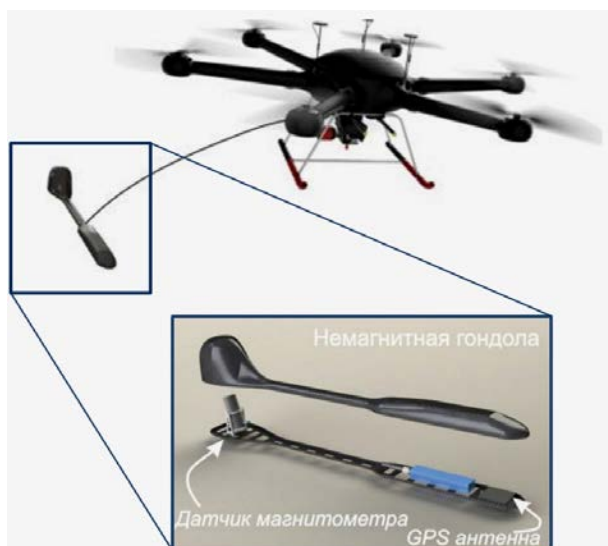
Рис. 2. Мультироторный беспилотный летательный аппарат с гибридным двигателем и серийным датчиком CS-3 в выпускной гондоле
