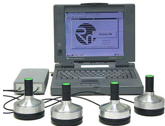
Рис. 1. Комплекс «Камера-01» для измерения плотности потока радона (ППР) с поверхности земли
