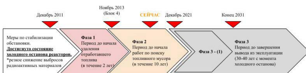
Рис. 1. Календарный план и схема основных периодов вывода из эксплуатации АЭС «Фукусима-Дайити» [4]
