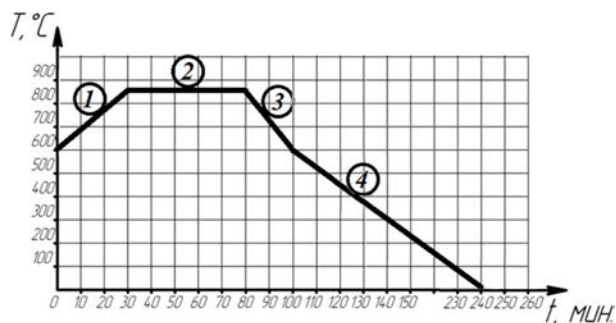
Рис. 1. Температурно-временной режим синтеза стеклокерамических материалов 1 – нагрев; 2 – вспенивание; 3 – резкое охлаждение (фиксация структуры); 4 – охлаждение (отжиг)
