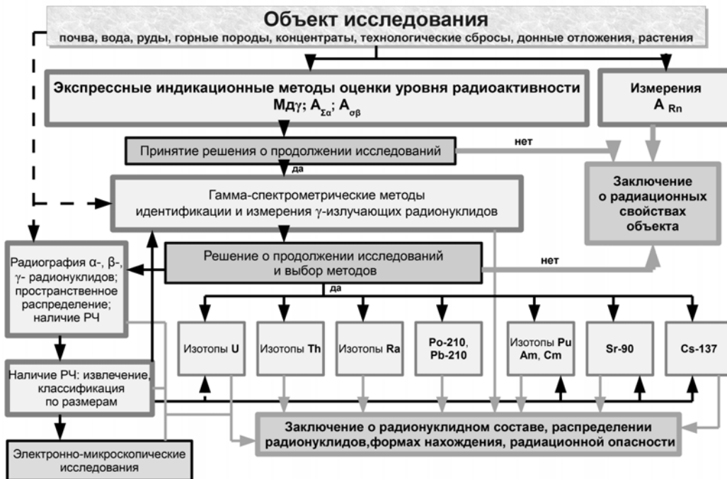
Рис. 1. Обобщенная блок-схема комплексных радиоизотопных, радиографических и электронно-микроскопических исследований объектов радиоэкологической оценки
