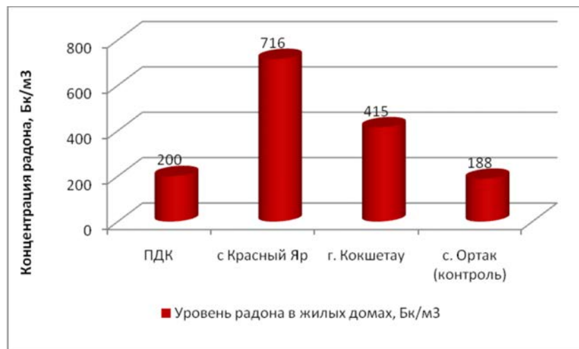
Рис. 3. Измерение уровня радона в жилых помещениях с. Ортак
