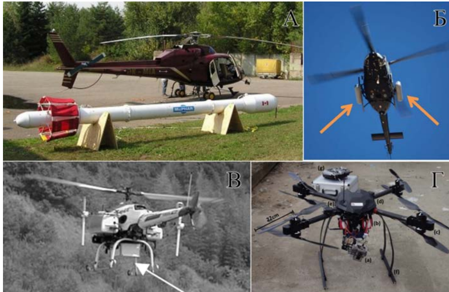
Рис. 1. Современные пилотируемые и беспилотные АГС-комплексы: а – пилотируемый вертолетный комплекс HUMMINGBIRD (McPHAR, Канада) для осуществления АГС (детектор объемом 16,8 л или 4,2 л), аэромагнитной и электромагнитной съемок [16]; б – пилотируемый вертолет с АГС-комплексом на основе детекторов большого объема (показаны стрелками) (National Security Technologies, США) [17]; в – беспилотный вертолет (АУН), модель RMAX G1 (Yamaha Motor Co., Ltd, Shizuoka, Japan) с гамма-спектрометром ARMS [4]; г – мультикоптер (UAV) с гамма-спектрометрическим комплексом на основе CZT детектора объемом 1 см 3 (University of Bristol, Великобритания) [10]
