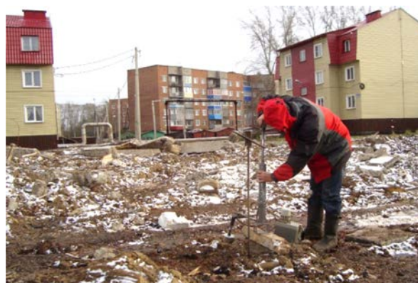
Рис. 1. Эманационная съемка эманометром Радон-М
