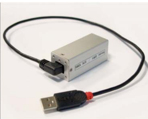
Рис. 3. Устанавливаемый на БПЛА гамма-спектрометр GR-1 Кротек (Великобритания) и его основные характеристики [8]
