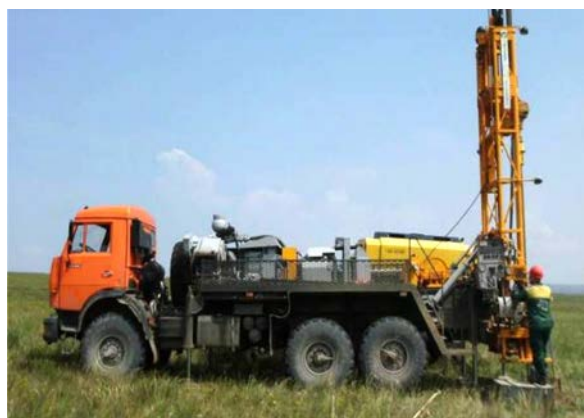
Рис. 1. Буровая установка ЛБУ 50-07
