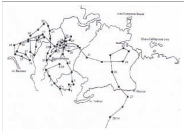
Рис. 1. Траектория переноса воздушных масс от места взрыва 16.04.1974 г на Семипалатинском полигоне: круги – приземная; квадраты – на высоте 1,5 км [7]
