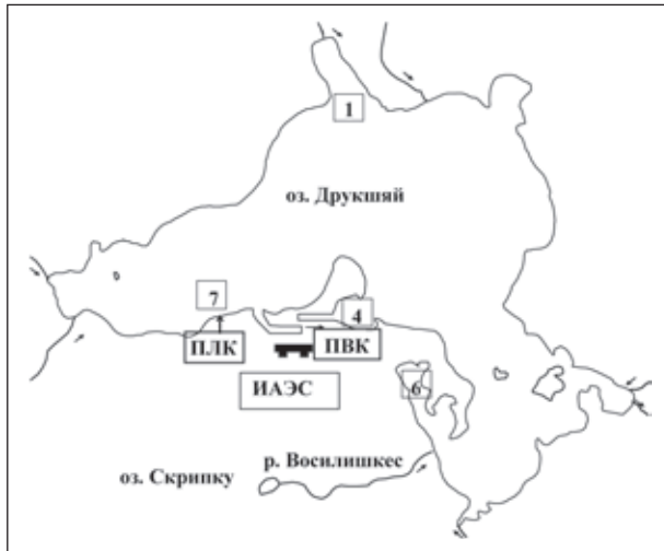
ПЛК-1,2 – канал промливневой канализации; ПВК – канал подогретой воды; 1, 4, 6, 7 – станции мониторинга, расположенные на различных расстояниях от объектов ИАЭС.
