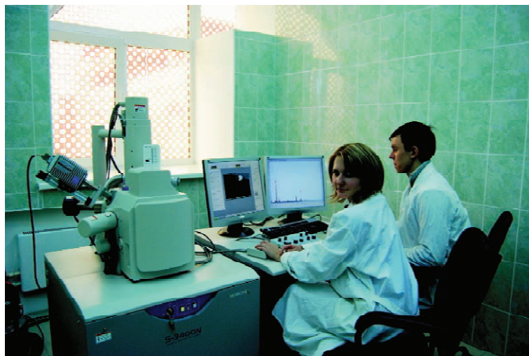
Рис. 2. Аспирант С.С. Ильенко и магистрант Н.К. Анищук осваивают электронный микроскоп Hitachi S-3400N, имеющий разрешение 3 нм с системой энергодисперсионного микроанализа Bruker, позволяющим определять элементный состав от лития до урана
