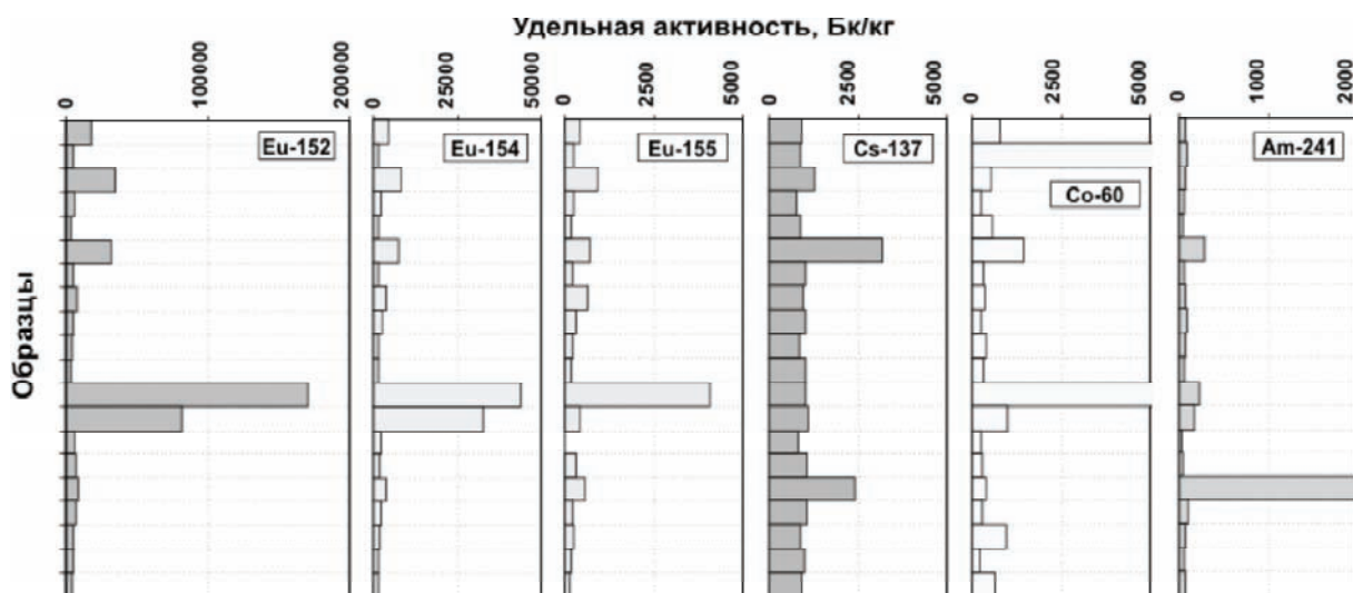
Рис. 1. Удельные активности техногенных радионуклидов в пробе П12А 2 (разрез почвы П12, о. Тайвань). По результатам измерения сверхмалых навесок массой 0,5 г [6]
