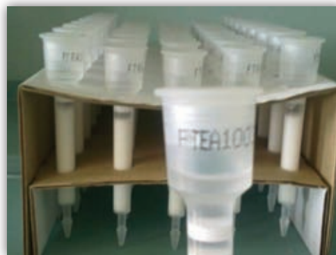
Рис. 2. Внешний вид экстракционно-хроматографических колонок (объем смолы 2 мл)
