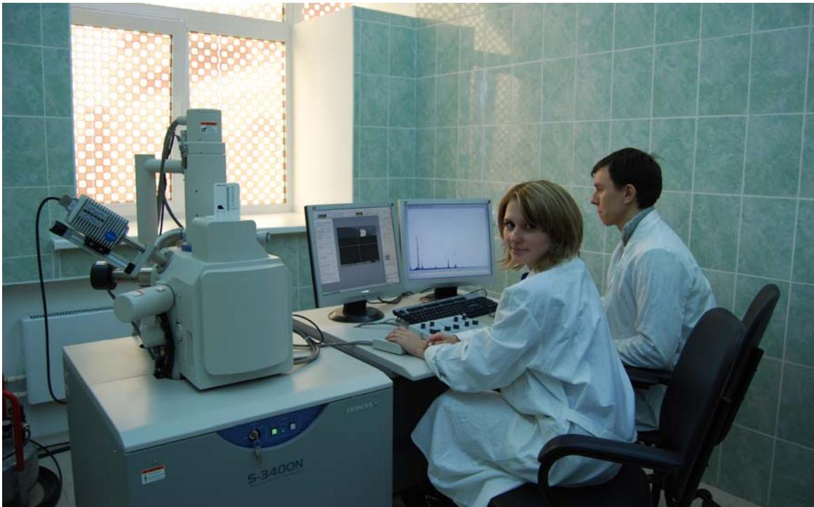
*Аспирант Ильенок С.С. и магистрантка Анищук Н.К. осваивают электронный микроскоп Hitachi S-3400N, имеющий разрешение 10 нм с системой энергодисперсионного микроанализа Bruker.*
