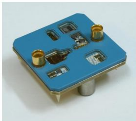
Рис.7 Одноканальный планарный приемный СВЧ-субмодуль X-диапазона
