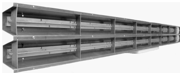
Рис.4. Внешний вид антенной решётки, размещаемой внутри защитного диэлектрического корпуса
