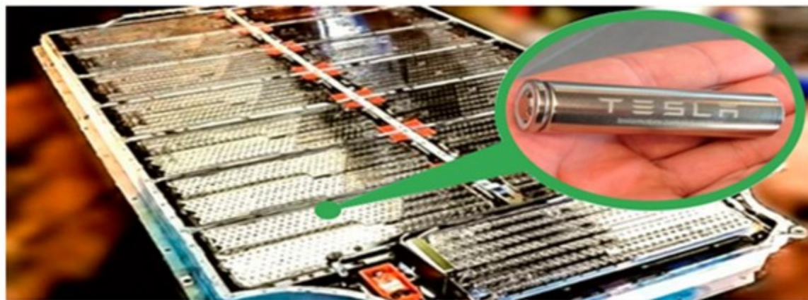
Аккумулятор Tesla model S (85кВт*час, 400В)
