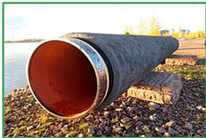
Внешний вид трубы "Северного потока" (масса 1 км трубопровода 2000 тонн)
