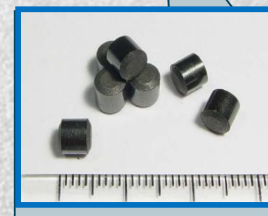
оксидный катализатор- гранулы 5x5 мм
