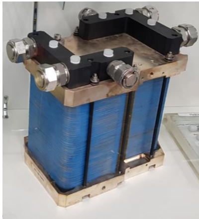
ПОМТЭ – протонообменный мембранный топливный элемент
