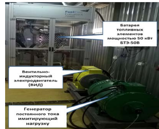
На стендовом комплексе создана демонстрационная модель системы электродвижения с электропитанием от батареи топливных элементов БТЭ-50В
