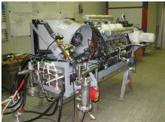
Автомобильная ЭУ на топливных элементах АЭУ-20 мощностью 20 кВт на основе батарей БТЭ-84 (2009 год)
