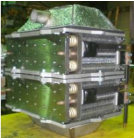
Батарея топливных элементов БТЭ-П мощностью 5 кВт, работающая на водороде и воздухе (2014 г.)
