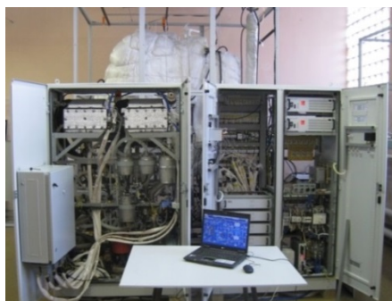
Электротеплогенератор на топливных элементах ЭТГ-10 на основе БТЭ-84 с конвертером природного газа (2009 год)
