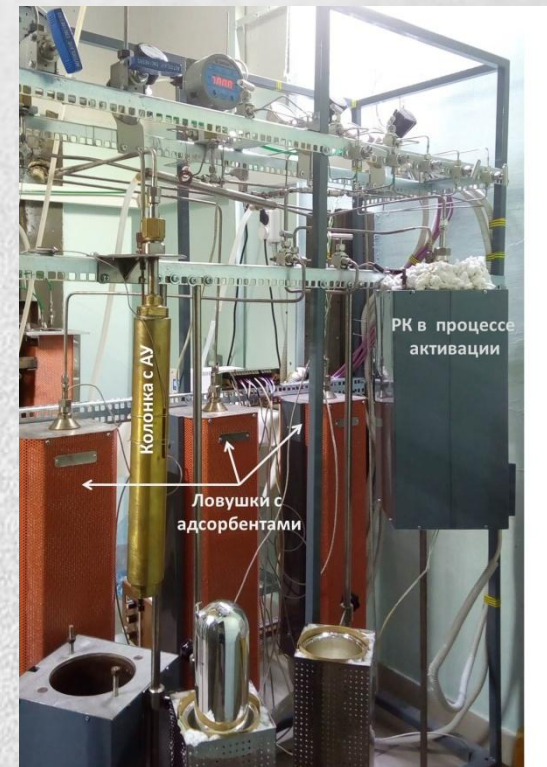
Схема, внешний вид стенда и реактора Орто-Пара конверсии H 2
