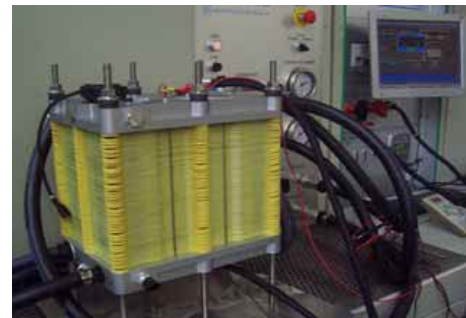
Батарея топливных элементов
