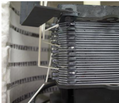
БАТАРЕЯ ТОТЭ В СТЕНДЕ
