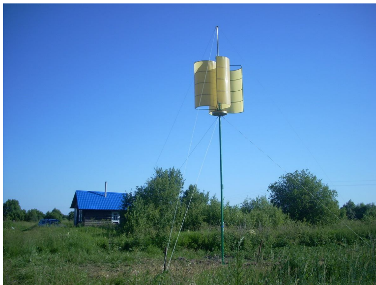
Рис. 1. Экспериментальная ветроэнергетическая установка с тихоходным электрогенератором
