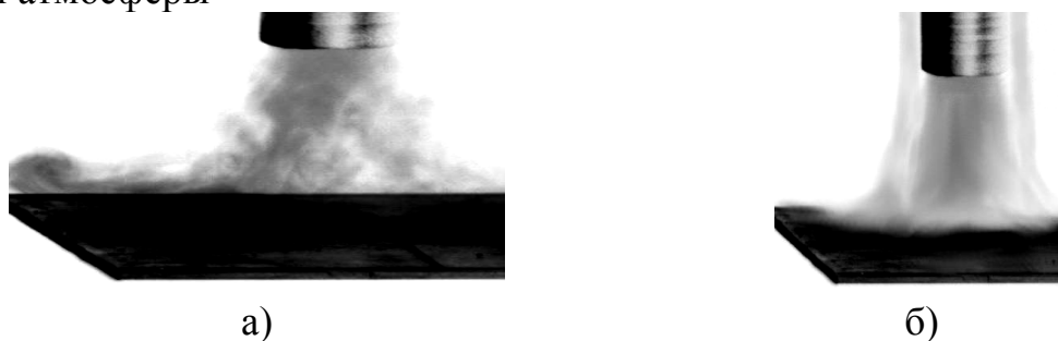
Рис. 1. Сварка в защитном газе: а) одноструйная газовая защита; б) двухструйная газовая защита
