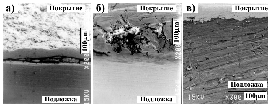
Рис. 1. Микрофотографии шлифов вертикального среза образцов с медным покрытием: а) из стали (Ст.3); б) из нержавеющей стали 12Х18Н9Т; в) из алюминия АД-31
