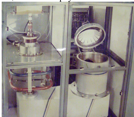
Рис. 1. Общий вид установки для микроволнового спекания
