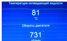
Рис. 2. Замер измерения температуры с помощью программы «Сканматик»
