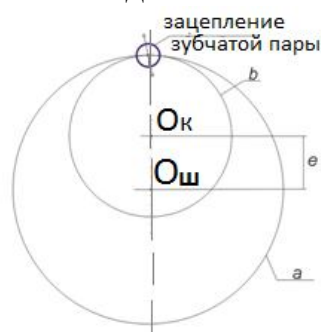
Рис. 3 Схема зацепления зубчатой пары: a - сканирующая шестерня; b - выходное колесо
