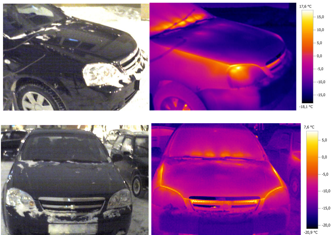
Рис. 1. Места утечек тепла из моторного отсека
