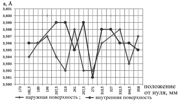
Рис. 6. Параметр элементарной ячейки \gamma -Fe для различных поверхностей
