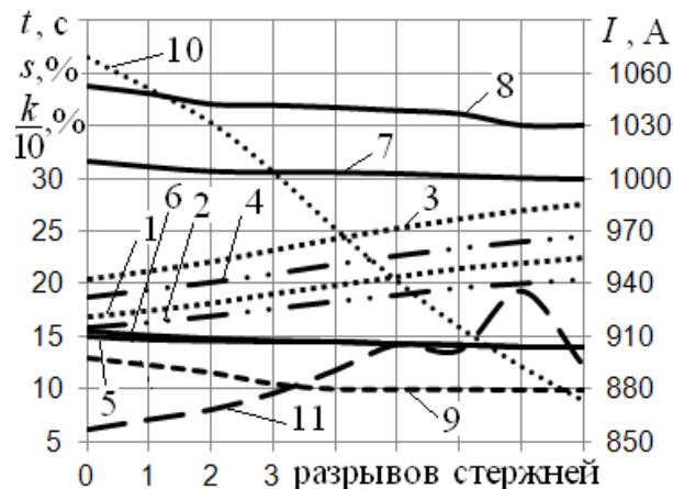
Рис. 1. Расчётные характеристики АД НВА-55 в функции количества разрывов стержней ротора: 1 – время достижения пазовой частью обмотки статора перегрева 135 °С; 2 - время достижения лобовыми частями обмотки статора перегрева 135 °С; 3 – время достижения пазовой частью обмотки статора перегрева 160 °С; 4 - время достижения лобовыми частями обмотки статора перегрева 160 °С; 5 – время достижения перегрева короткозамыкающих колец ротора 300 °С; 6 – время достижения перегрева стержней ротора 300 °С; 7 – время достижения перегрева короткозамыкающих колец ротора 600 °С; 8 – время достижения перегрева стержней ротора 600 °С; 9 – коэффициент небаланса междуфазных напряжений, % (уменьшено в 10 раз); 10 – действующий ток установившегося режима фазы С2, А; 11 – скольжение ротора АД, %
