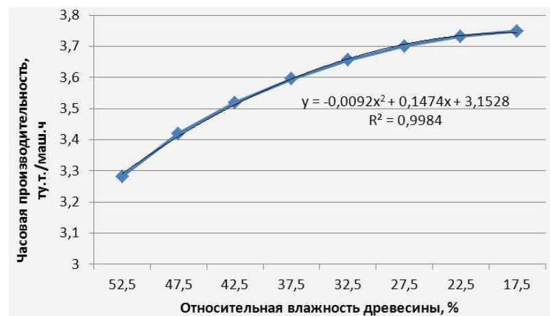
Рис. 1. Зависимость часовой производительности установки по готовой щепе от влажности измельчаемой древесины
