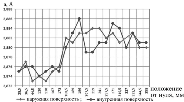
Рис. 5. Параметр элементарной ячейки \alpha -Fe для различных поверхностей
