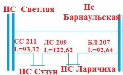
Рис.1. Участок Алтайской энергосистемы
