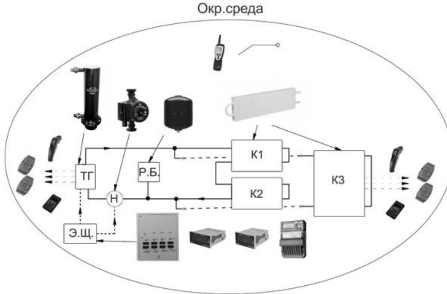
Рис. 1. Основные блоки источника энергии в виде лабораторно-вычислительного стенда «Децентрализованная система отопления с электродным источником теплоты».
