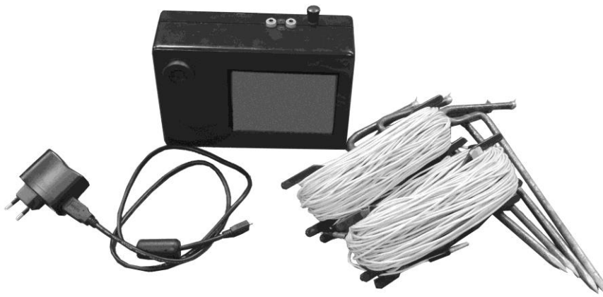
Рис. 3. Внешний вид измерителя сопротивления заземления опор ЛЭП
