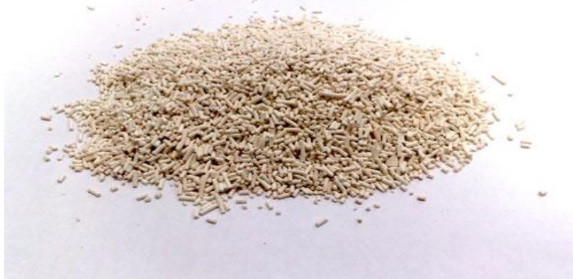
Рисунок 1. Внешний вид сорбента КФГМ-7
