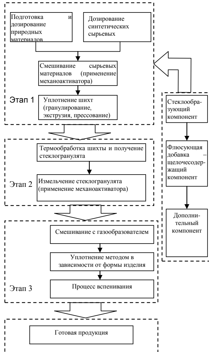
Рис. 1. Принципиальная технологическая схема получения пеностеклокристаллических материалов
