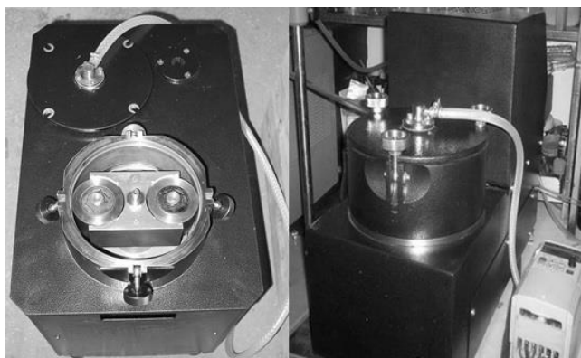
Рис. 1. Шаровая планетарная мельница АГО-2С
