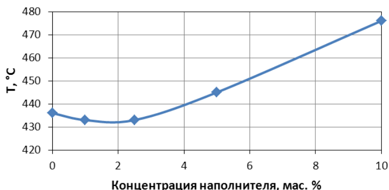
Рис. 2. Изменение температуры 50%-ной потери массы образцов в зависимости от концентрации наполнителя
