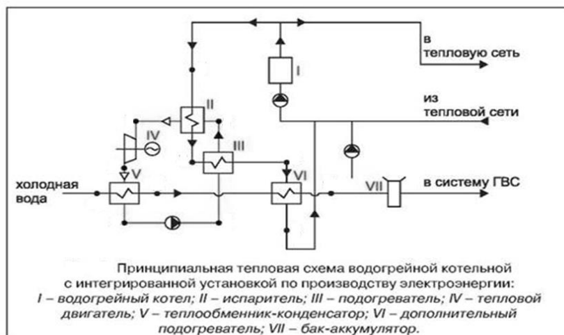
Рис. 2. Принципиальная тепловая схема бутанового контура
