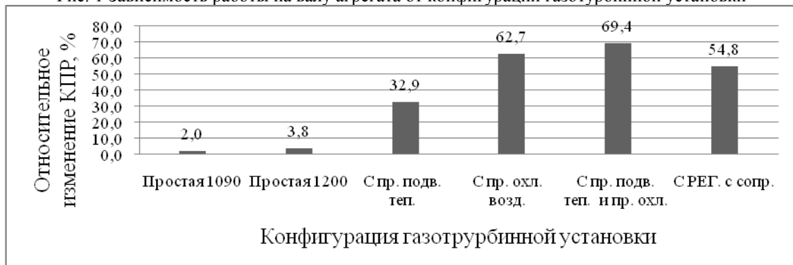
Рис. 2 Зависимость коэффициента полезной работы от конфигурации газотурбинной установки
