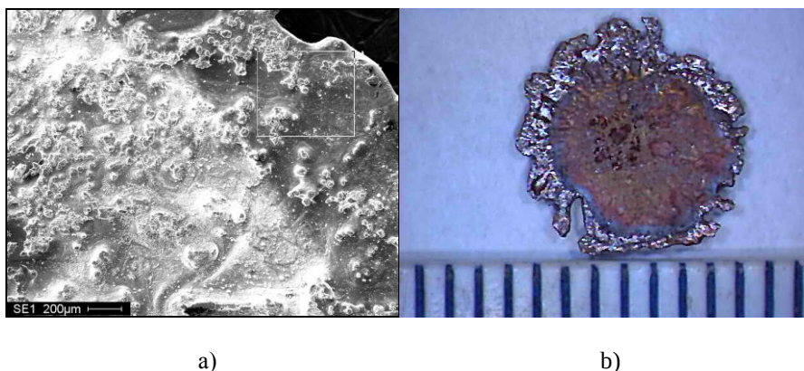
Рис. 4. Фотография поверхности контакта капли расплава с подложкой (a) и снимок поверхности (b), сделанный с помощью электронного микроскопа.
