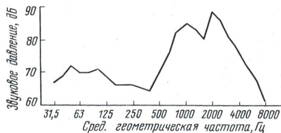
Рис. 2. Третьоктавный спектр шума в примагистральной территории на расстоянии 25 м от пути с рельсами без волнообразного износа при прохождении поезда, оснащенного колодочными тормозами, со скоростью 160 км/ч (уровень звука 93дБА).
