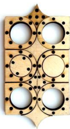
Рис. 7. Вырезанные детали на лазерном станке.
