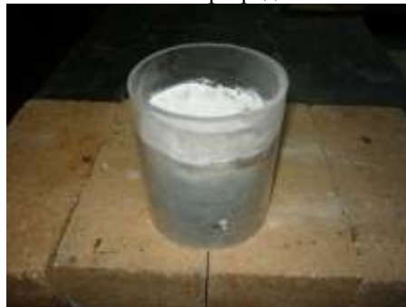
Рис. 4 – Образец продукта плазменной иммобилизации твердых дисперсных продуктов ИЛО в расплаве хлорида натрия в воздушной плазме ВЧФ-разряда.
