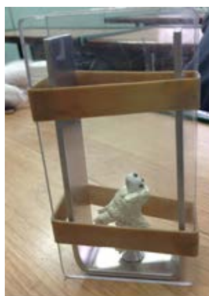
Рис.4. Установка пластилиновой модели в пресс-форму
