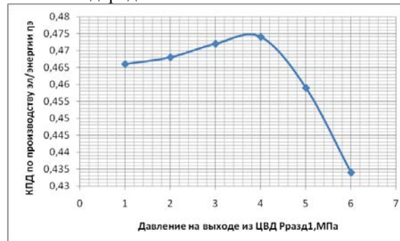
Рис. 4 - График зависимости изменения КПД по выработке эл/энергии от давления на выходе из ЦВД для перегрева со сжиганием водородного топлива.
