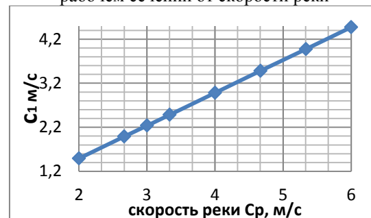
Рисунок 5 – Зависимость скорости потока на выходе из направляющих лопаток от скорости реки
