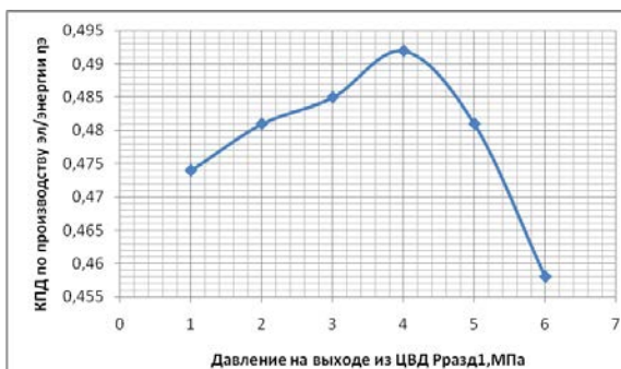
Рис 3. – График зависимости изменения КПД по выработке эл/энергии от давления на выходе из ЦВД для газового перегрева.
