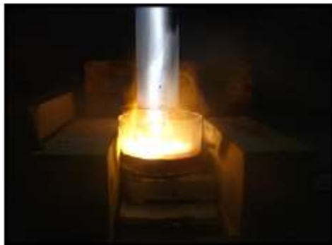
Рис. 3 Плазменная иммобилизация твердых дисперсных продуктов ИЛО в расплаве хлорида натрия в воздушной плазме ВЧФ-разряда.
