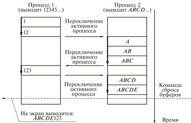
Рис. 8.2. Сброс буферов ввода/вывода параллельно выполняемых процессов:
